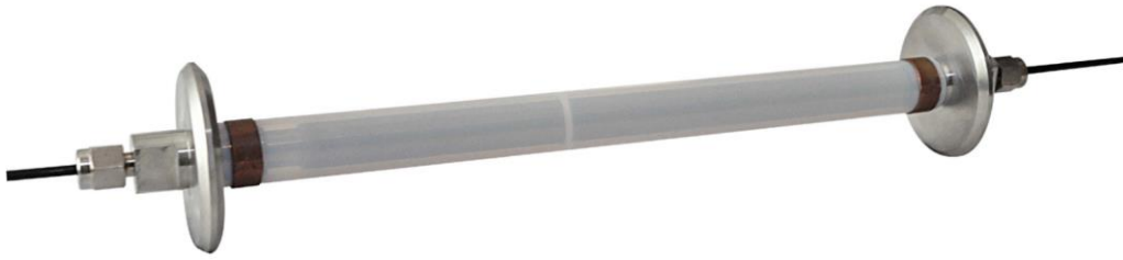
Kuva 5. Pölkyn venymää mittaava valokuituanturi.
