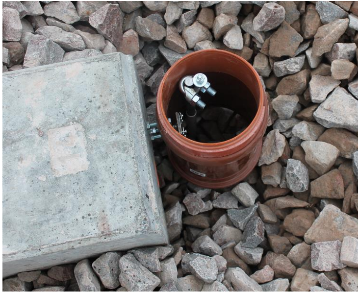
Kuva 10. Pölkyn pystysuuntaista liikettä mittaavan anturin kiinnike ja sen referenssitasona toimiva kairatanko suojuksineen.
