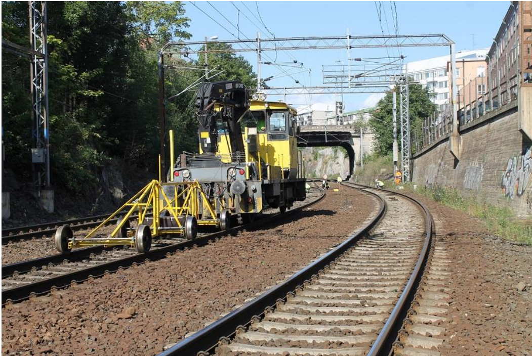
Kuva 9. TTY:llä kehitetty radan palautuvaa painumaa mittaava laite.
