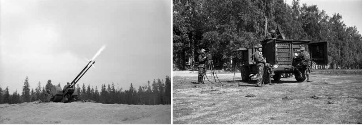
■ Kuvissa ovat vasemmalla 30 ItK/62 Hispano Suiza ja keskellä 35 ItK/58 Oerlikon, joka sai 1980-luvulla tehdyn modernisoinnin myötä nimekseen 35 ItK/88. Oikealla on 35 ItK/58 Oerlikon automaatti-ilmatorjuntajaksen Super Fledermaus -tulenjohtotutka. Kuvat: Sotamuseo.
