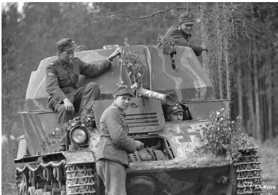
■ Ilmatorjuntapanssarivaunu 40 ItPsv 41 – Landsverk Anti II – Karjalankannaksen Liikolassa 15.6.1944. Ilmatorjuntapanssarivaunu oli varustettu 40 mm:n ilmatorjuntakanuunalla. Kuva: SA-kuva.
