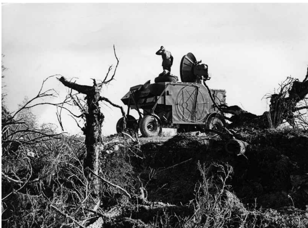
■ Ilmatorjunnan tulenjohtotutka Radar AA N:o 3 Mk 7 tunnettiin Suomessa nimellä VRTTI. Kuva: Sotamuseo.
