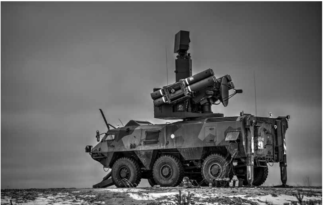
■ Ranskalainen Crotale NG tunnetaan Suomessa nimellä Ilmatorjuntaohjus 90, ja sen 2000-luvulla modernisoitu versio on Ilmatorjuntaohjus 90M. Kuva: Puolustusvoimat.
