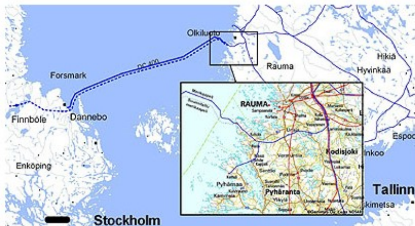
Kuva 15: Fenno-Skan 1 ja 2 – sähkönsiirtokaapeleiden reitit. 266
