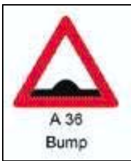
Kuva 4.4 Tanskalainen ajoradan korotuksen liikennemerkki. Korotuksille on toivottu vastaavaa omaa liikennemerkkiä myös Suomessa.
