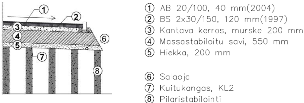
Kuva 30. Tilanhoitajankaari. Viikin savikadun poikkileikkauksen periaatekuva (Mäkelä et al. 2000, muokattu).
