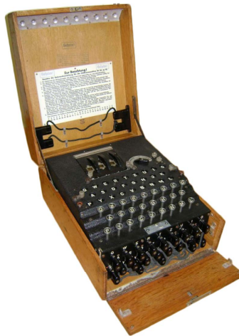
Figur 2.7: Militär Enigmamaskin med kopplingsbord (tys. steckebrett, eng. plug-board) längst fram.
