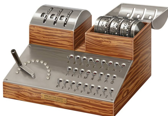
Figur 4.2: Ett möjligt utseende för den polska cyklometern som Rejewski och hans kollegor utvecklade.
