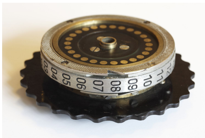
Figur 2.3: En Enigma rotor där man ser "hacket" vid 08/07 som bestämmer när nästa rotor roterar.
