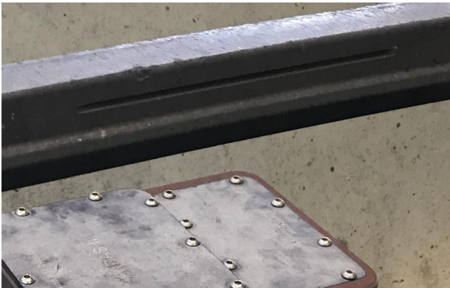
Kuva 17. Kulumaa indikoiva ura virroittimen hiilessä.
