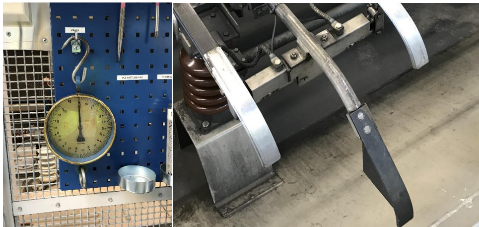
Kuva 15. Vasemmalla puolella virroitin nostolaitteen muodostavan pystysuuntaisen voiman mittausvaaka ja oikealla puolella musta aerodynaaminen ohjain.
