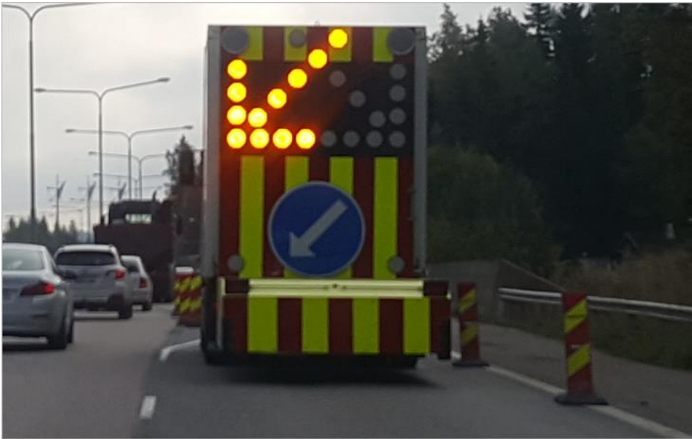
Kuva 21 Tiementyökalu, jossa varoituspaneeli ja törmäysvaimennin.
