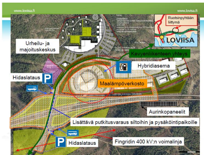
Kuva 7 Kaaviokuva Vihreälle moottoritiele E18 suunnitellusta hybridiasemasta [17]
