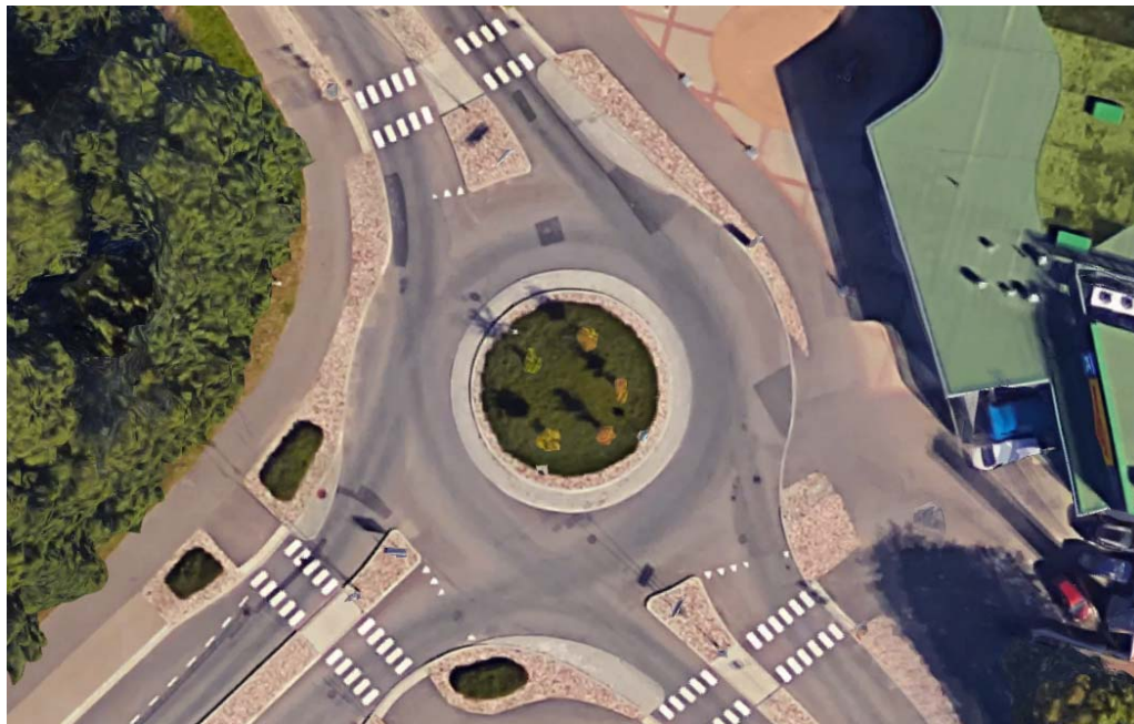
Kuva 37. Louhelantien ja Uomatien kiertoliittymä Vantaalla, jossa poistumissuuntia on kavennettu yliajettavilla korokkeilla. (Google Maps 2017)
