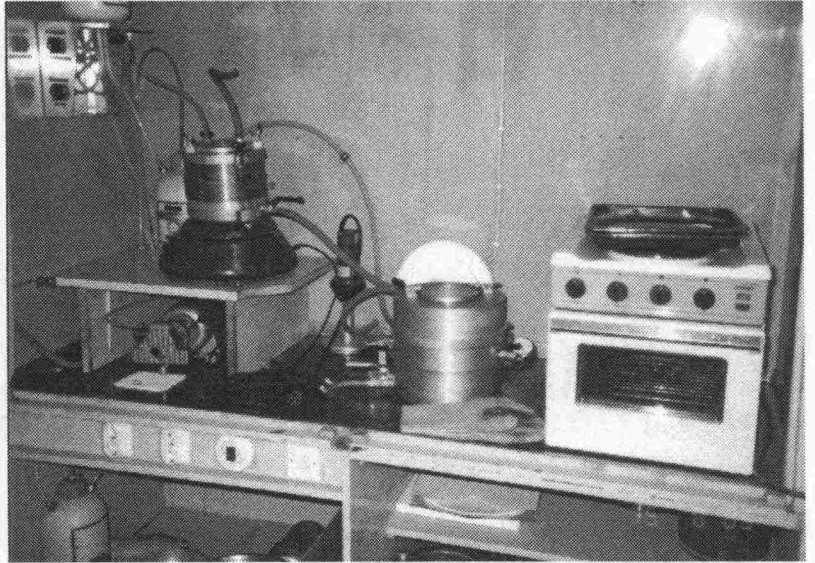
Päällystelaboratorion suljettu uuttosuodatinlaitteisto. Kuva: J. Rapila
