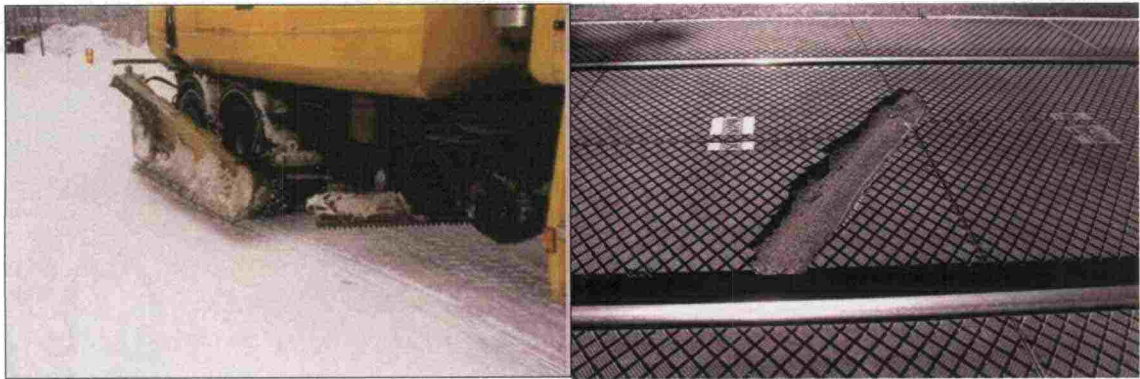
Kuva 82. Auran terät vaurioittavat kumikantta, jonka voi korjata vain vaihtamalla uudet elementit. Hinta arviolta 3000 euroa vuoden 2008 hinnoin.
