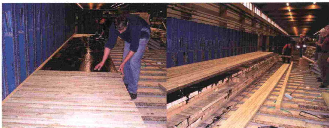
Kuva 32. Keskielementtien 3-kerrosvalmistus kahdella ristikkäisvaihtoehdolla.
