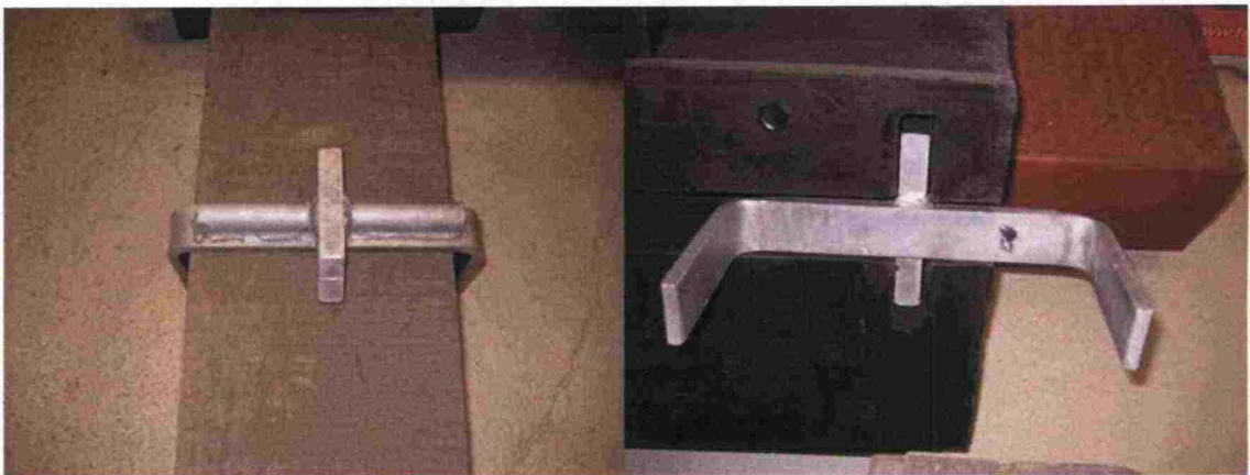
Kuva 43. Vaeltamisen estävä ankkuri, joka tukeutui pölkkyyn ja elementissä olevaan koloon. Tämä ei ole riittävä.
