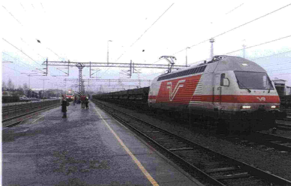
Kuva 5.29 Kokkolan ratapihaa: vasemmalla matkustaja- ja linjaliikenteen raiteet, oikealla vaihtotyö- ja junanmuodostusraiteet (tavarajunasta alkaen).
