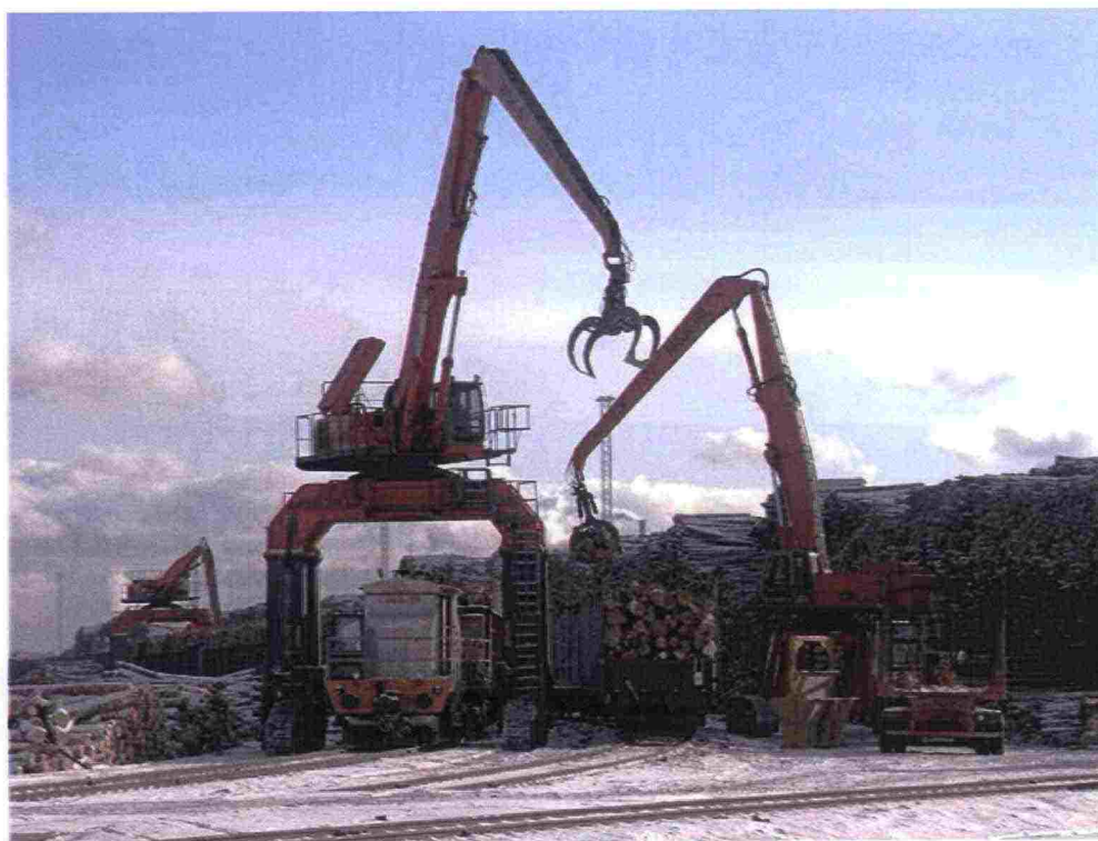
Kuva 5.33 Pelkolan puutermiinalin radio-ohjattava vaunusiirtolaite (kuorman- käsittelylaitteen jalkojen välissä).
