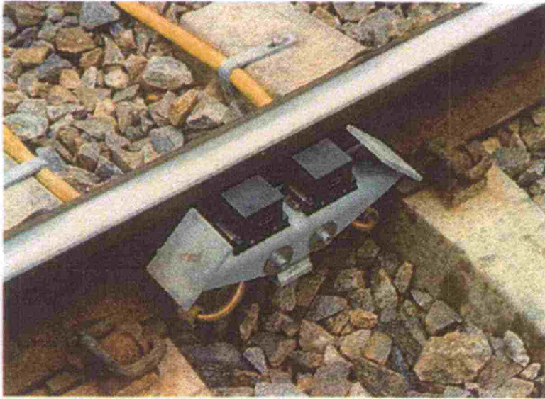
Kuva 9.1. Akselinlaskentalaitte. (Lähde: RHK)
