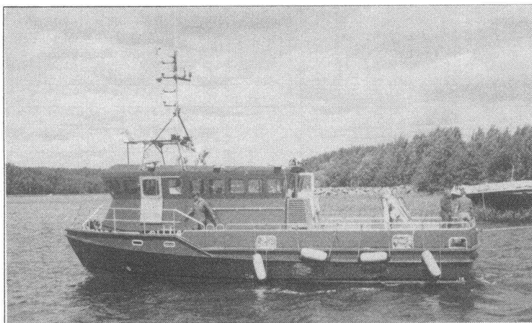
Kesällä 1995 valmistui uudentyypinen tutkimusalus, Merilla, jonka suurin pituus on 14,9 metriä, suurin leveys 4,5 metriä ja suurin syväys 1,6 metriä.
