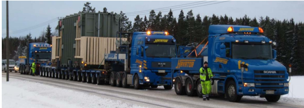
Kuva 22. Esimerkki suurmuuntajakuljetuksesta moduulilavettikalustolla (kuva: Havator).
