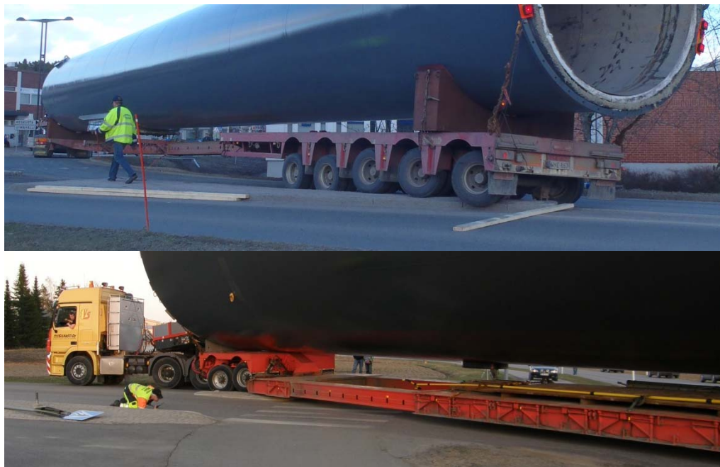
Kuva 3. Jousituksen ja maavaran korkeuden säätövara on eri kalustoilla erilainen (kuvat: Kaisu Laitinen).
