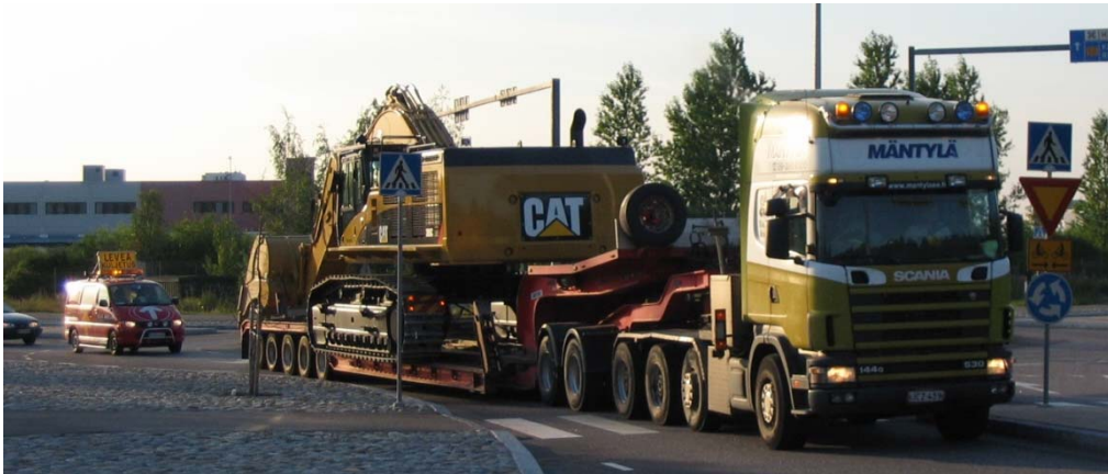
Kuva 20. Esimerkki kehtolavettikuljetuksesta, jossa kuorma on leveimmillään kehtolavetin kuormatilan matalimmalla kohdalla (kuva: Juha Savolainen).
