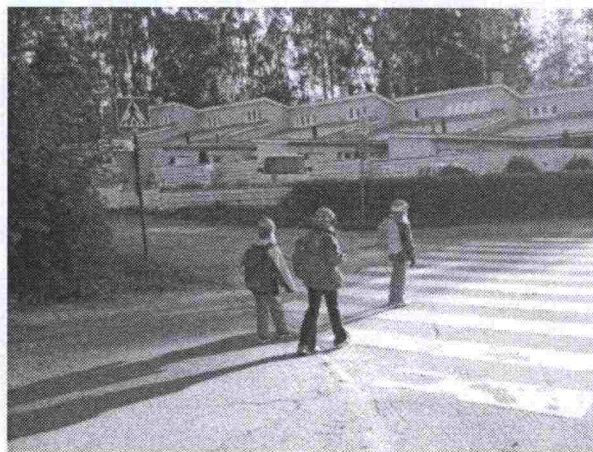
Kuva 11. Heikot näkemät koulureitin liittymässä. Lähestyvä liikenne näkyy vasta joukon kärjessä kulkevan tytön kohdalla.
