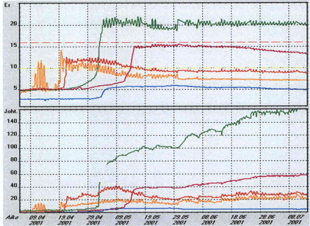
Kuva 2. Koskenkylän Percoasemalla mitatut dielektrisyydet (ylhällä) ja sähkönjohtavuudet (alhaalla) keväältä 2001. Antureita kuvaavat värit ovat seuraavat; 0,15 m oranssi, 0,35 m punainen, 0,55 m vihreä, 0,80 m violetti ja 1,2 m sininen.
