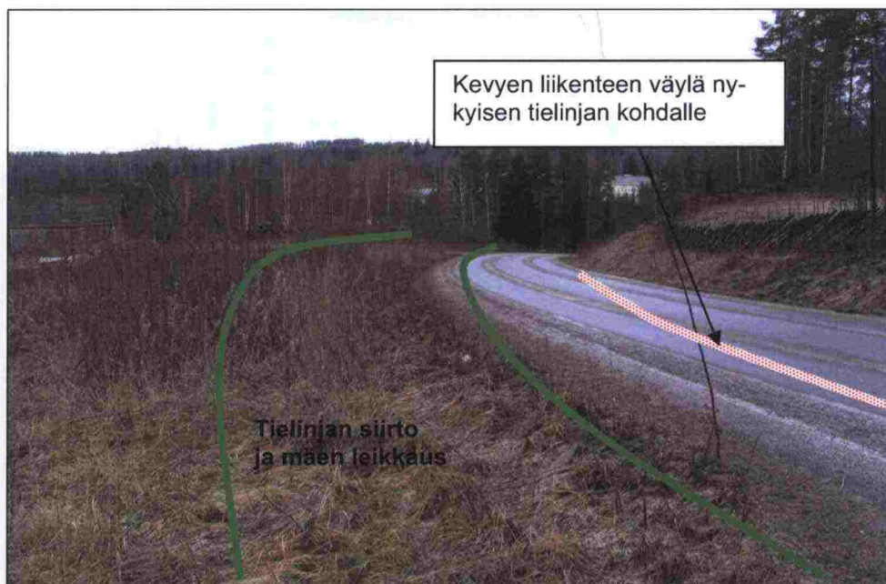
Kuva 4-2. Hessun mäen päällä kuvassa oikealla oleva aita ja kuva ulkopuolella oleva rakennus rajoittavat kevyen liikenteen väylän rakentamista tien itä-/pohjoispuolelle. Mäen laki on tiejakson ainoa kohta, josta avautuu näkymä kaukomaisemaan.
