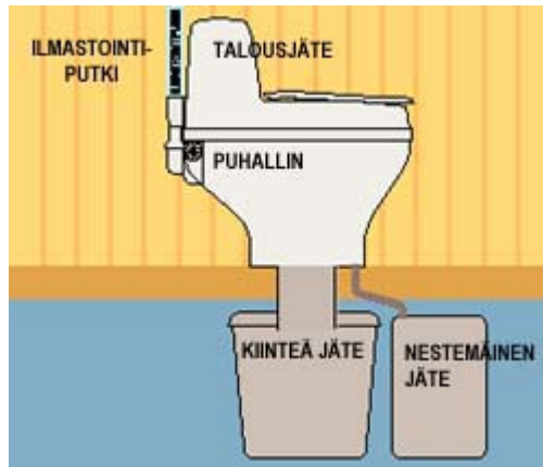
Kuva 3. Biolet UFA virtsanerotteleva kuivakäymälä
