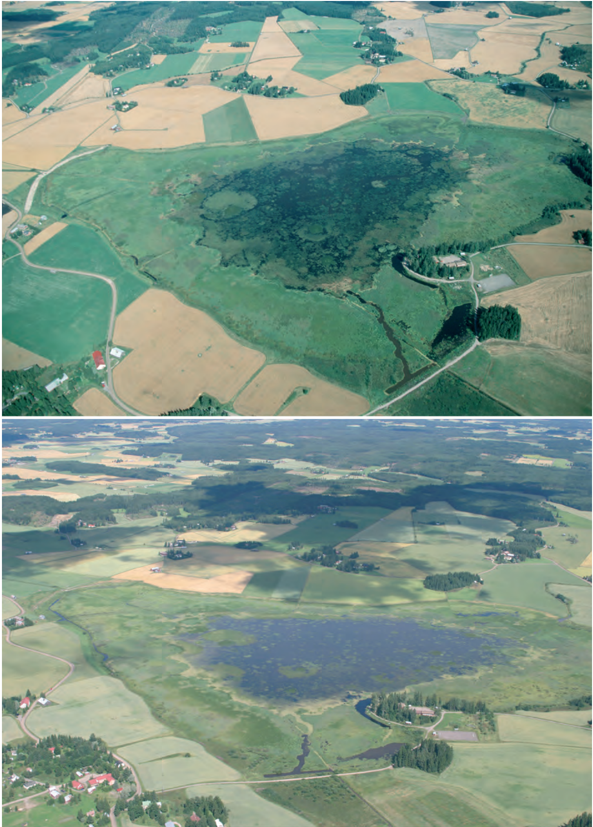
Kuva 14. Kanteleenjärvi elokuussa 2001 (ylempi kuva) ja heinäkuun lopulla 2005 (alempi kuva). Kuvien ottamisen välillä tehty pinnannoston toinen vaihe on selvästi vähentänyt avovesialueen kasvillisuutta. Järven pohjoispään patopenger erottuu ylemmän kuvan vasemmassa reunassa vaaleana kaarena. Eteläpään tiepenger ja kaivetut allikot sekä veneväylät näkyvät kuvissa etualalla.
