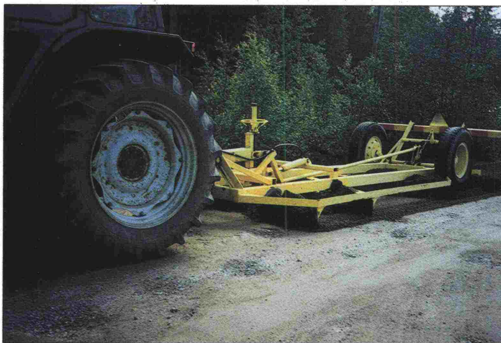
Kuva 11. Lana kulutuskerroksen tasauksessa.
