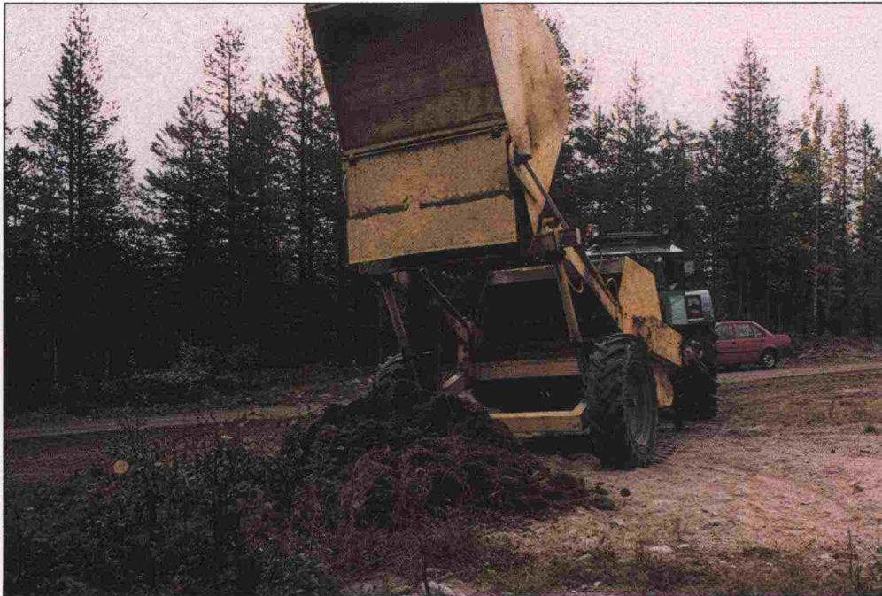
Kuva 14. Kivipoimurilla poistetaan tarvittaessa kivet, turpeet yms. epäpuhtaudet.
