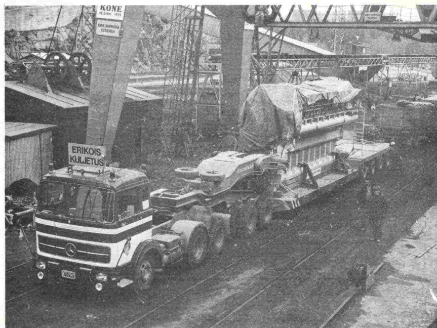
KUVA 6. 74 TONNIN PAINOINEN DIESELMOOTTORI LASTATTUNA 8,5 m MITTAISELLE KEHDOLLE. KUORMALAVA ON NOSTETTAVISSA JA LAS- KETTAVISSA KUORMAUKSEN HELPOTTAMISEKSI VÄLIVAUNU JA NELJÄ AKSELIRIVIÄ LAVETTIN TAKANA JAKAVAT AKSELIPAINON TASAISESTI
