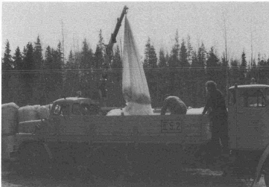
Kuva 7. Jättisäkin tyhjennys. Sisäsäkki valuu ulos liian suures- ta aukosta
