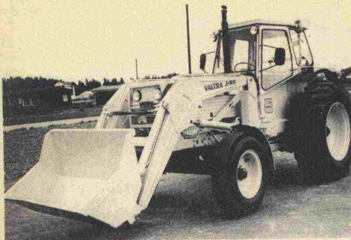
Kuva 1. Pyörätraktori Valmet 1102 etukuormaimella J-80
