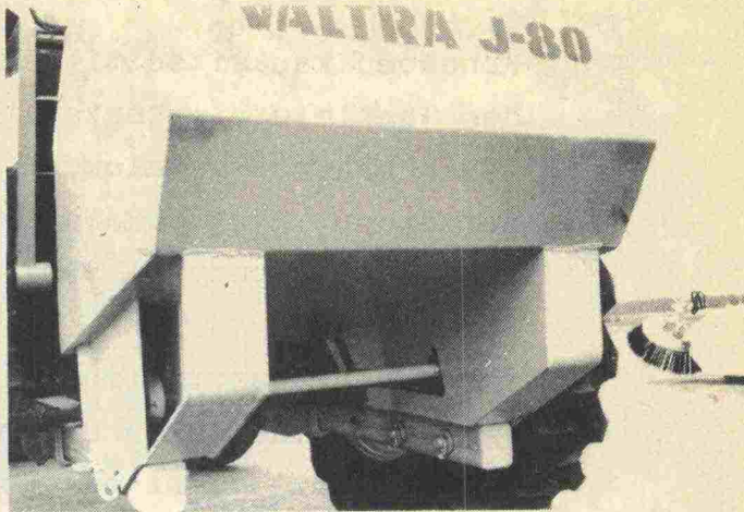
Kuva 32. Etukuormaimen J-80 vastapaino
