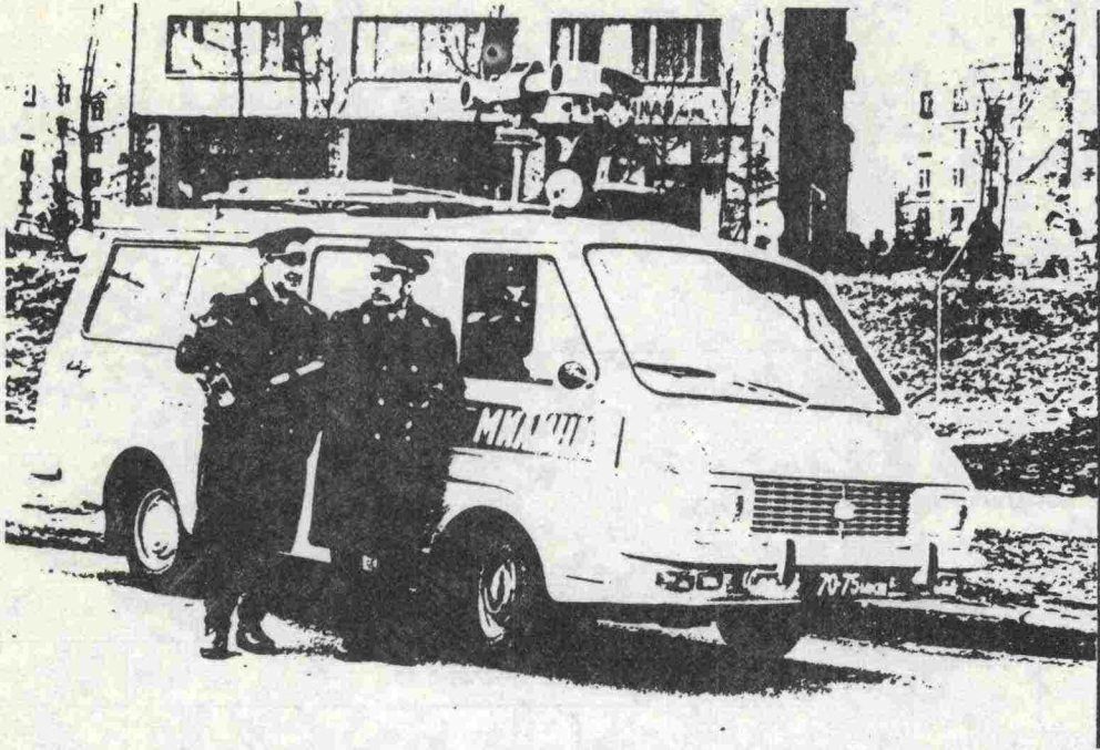
Kuva 1. Onnettomuuksien poliisitutkinnassa käytettävä auto stereokameroineen.
