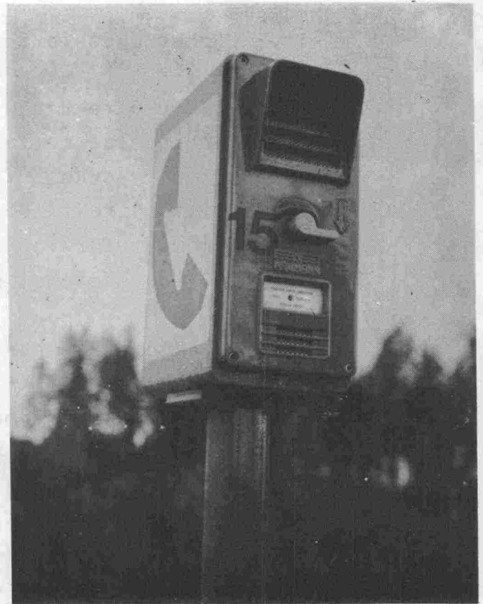
Bild 11.4 Mindre nödtelefon- modellet
