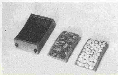
Kuva 35: Hioutuvuuden mittaus. a. mittauslaitteet b. koekappaleet.
