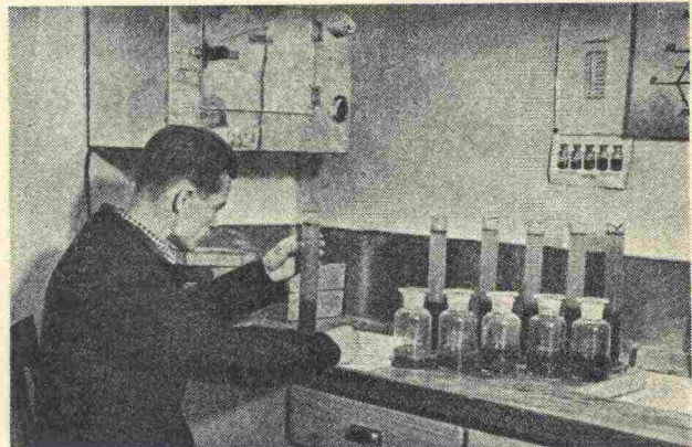
Humus- ja lietekokeilla selvitetään betonisoran puhtautta. (Kuva Kuopion tv-piirin laboratoriosta).
