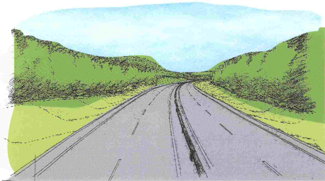
Kuva. Kapea 4-kaistainen tie teräsputkikaiteella 17,7/13,5.
