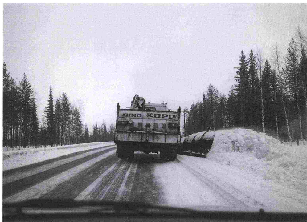
写真19: サイドウィングを使って雪堤を低くする
