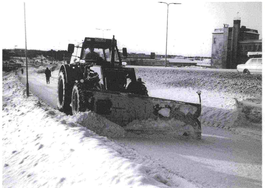
写真17：歩道と自転車道路の除雪。プラウには穴を開けたスチール製の目の粗いカッティングエッジが付いている。
