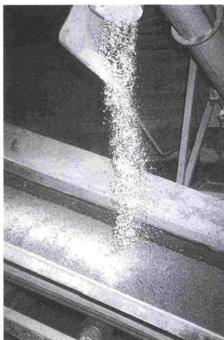
写真31：ベルトコンベヤーに塩をちらばせている。送り量は光学センサーでコントロールする。
