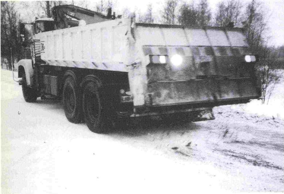
写真29： ロールシャフト散布機を使った砂／塩混合物の散布。後部扉の幅全体に均等に散布される。
