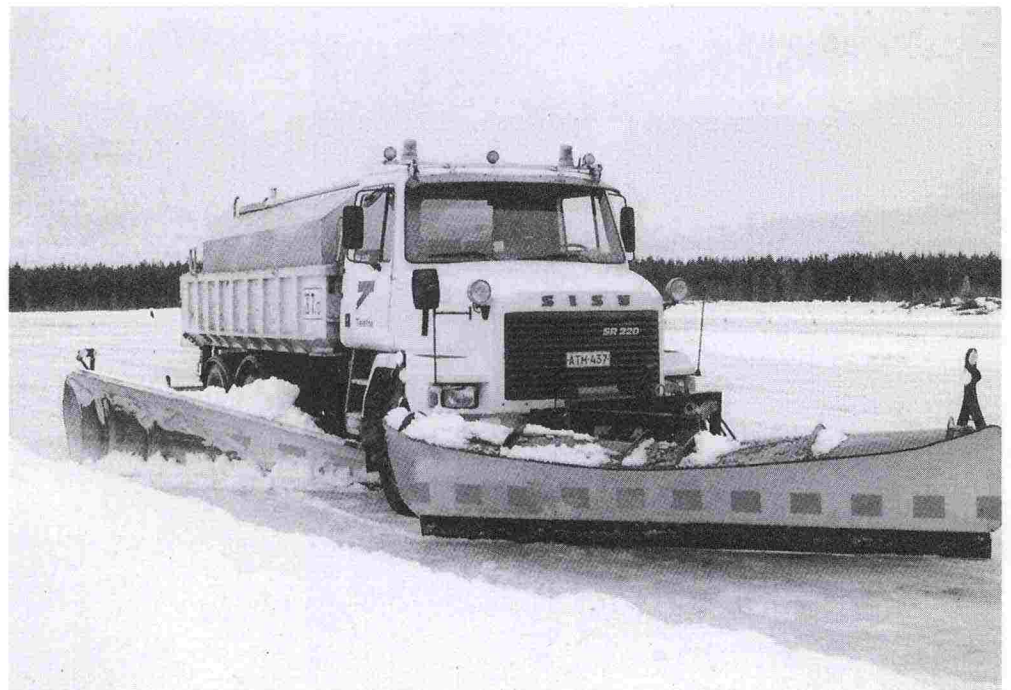
写真9：2ウェイスノープラウと同時に使われるサイドウィング
