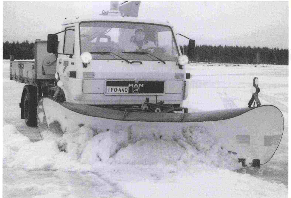
写真5：2ウェイスノーブラウ。作業幅は3から4m。
