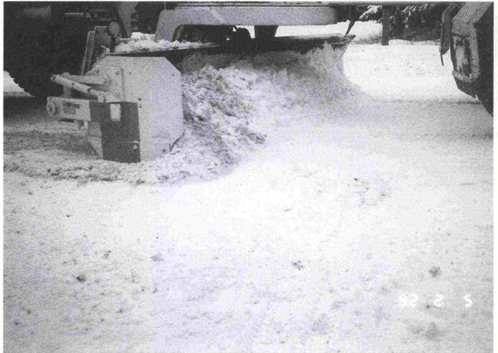
写真11：雪止めフランジ
