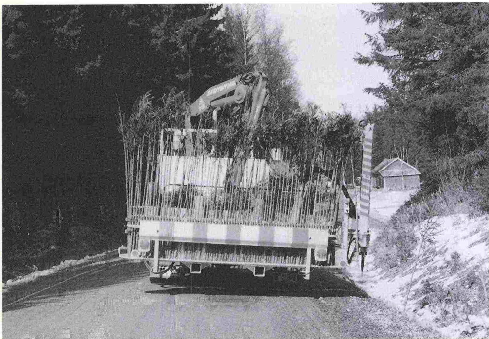
写真1：トラックに取り付けた自動スノーボール設置装置
