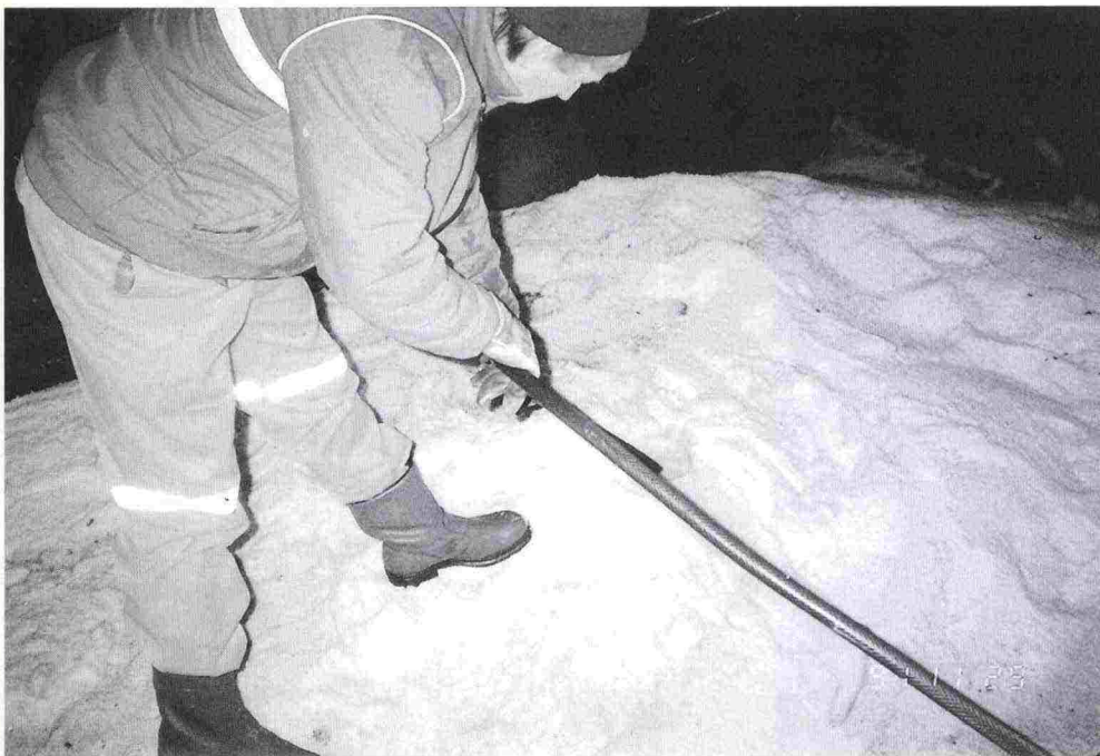
写真25：トラックのボックス内での水によるプレウエットイング
