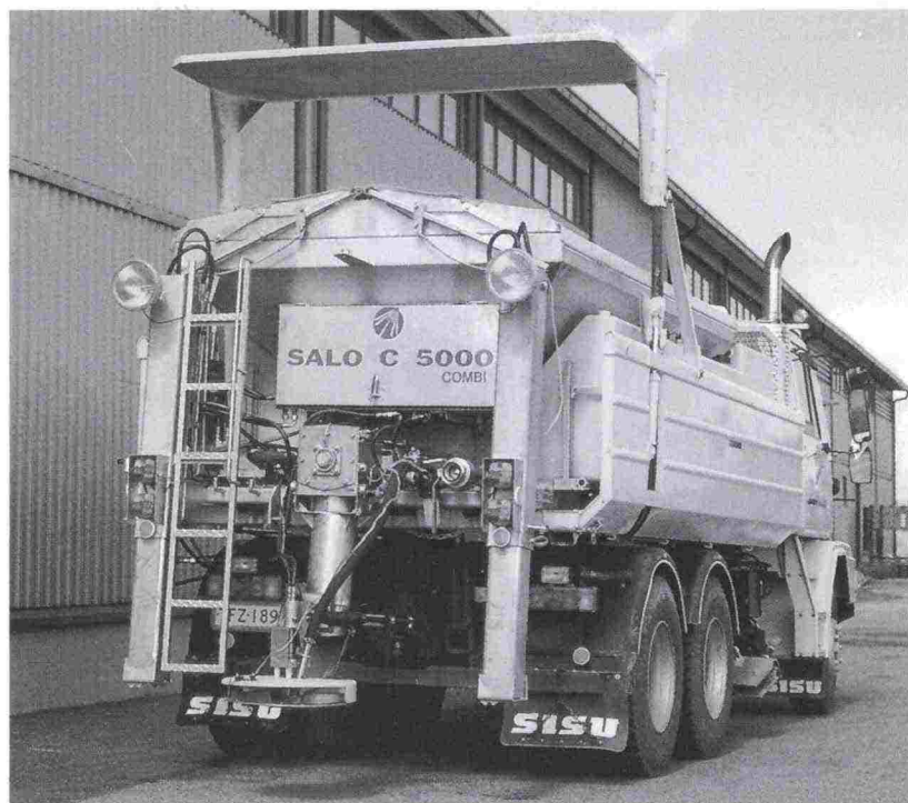
写真35: このコンビネーション散布機は塩/砂、プレウエット物質、および液体を散布することができる。
