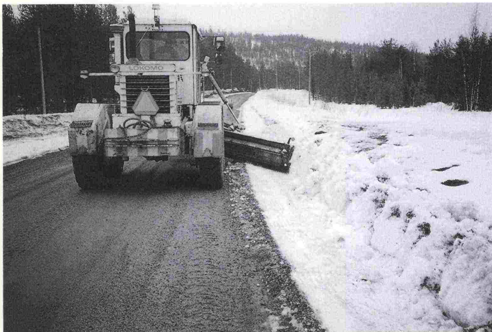
写真20: モーターグレーダー・ブレードを使つての雪堤の路肩への押し出し
