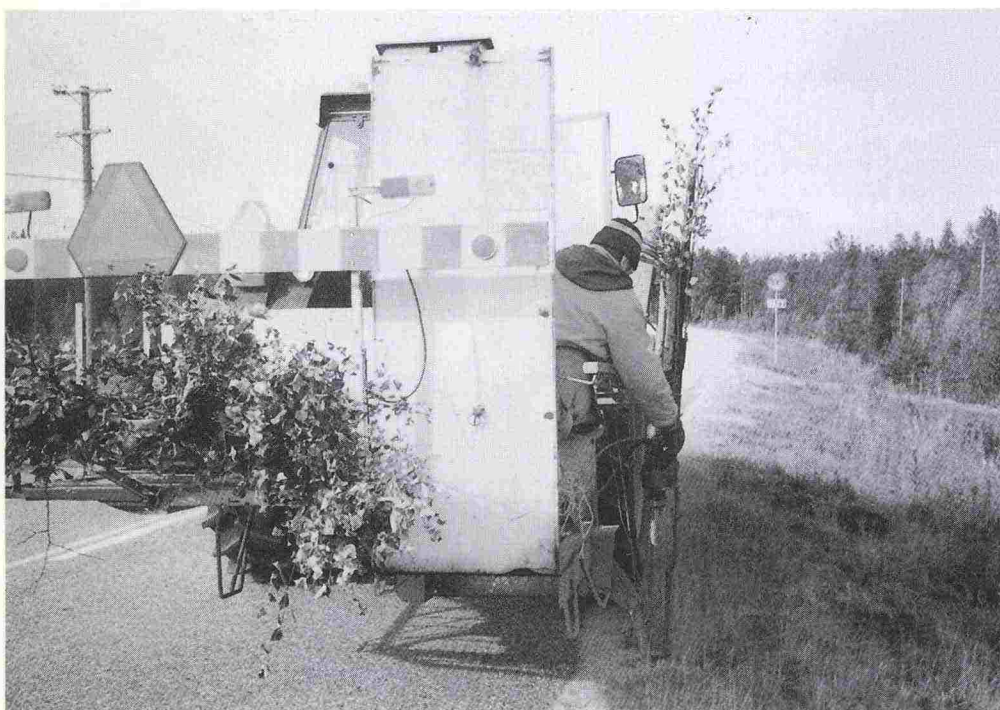
写真2：軽トラックに取り付けたスノーボール設置装置
