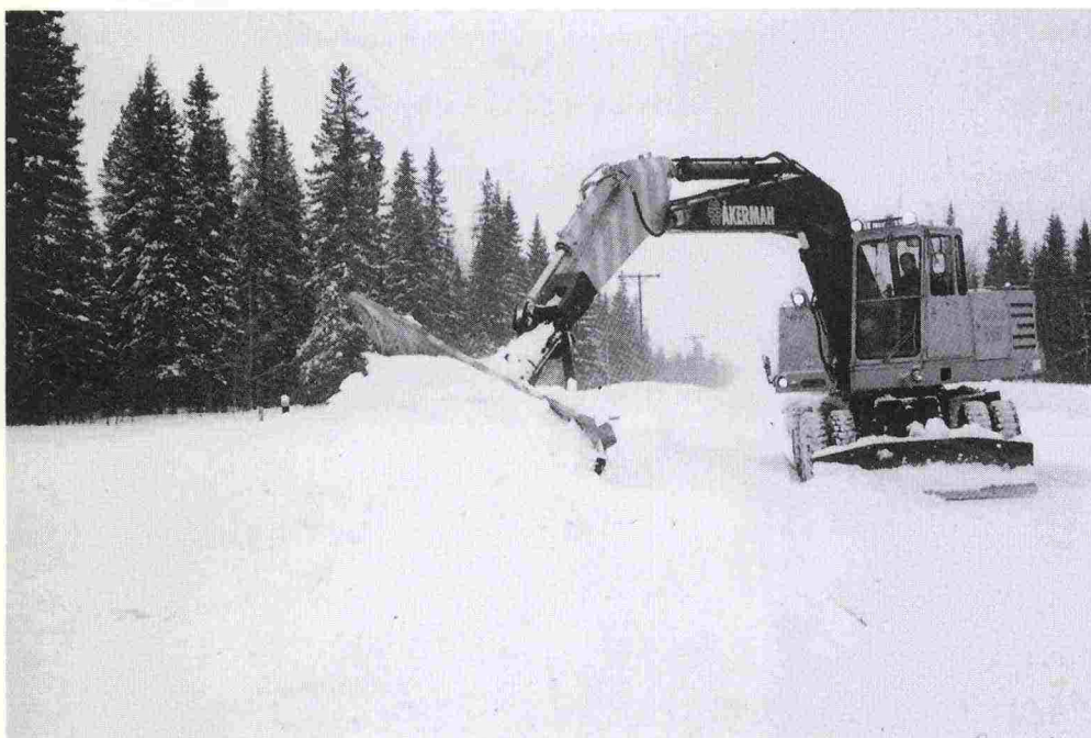
写真13：雪堤を低くするのに適当なブレードをつけたバックホウが使用される。
