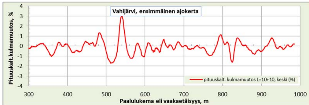
Kuva 4.5b. Tien pituuskaltevuuden kulmamuutos kuvan 4.1 kaavalla laskettuna, kun L_1 = L_3 = 5 m (kuva 4.5a) ja kun L_1 = L_3 = 10 m. Ensimmäinen nollamittaus.
