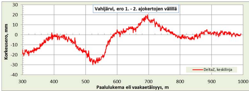
Kuva L4.2. Kahden eri nollamittauksen välinen korkeusero. Mitään todellista korkeuden muutosta ei samana päivänä tehtyjen mittausten välillä ole tapahtunut. Ero kuvaa siis mittaus- ja tulostenkäsittelyprosessin epätarkkuutta (tässä kohdassa -30 - +20 mm, ks. kuvat alla).
