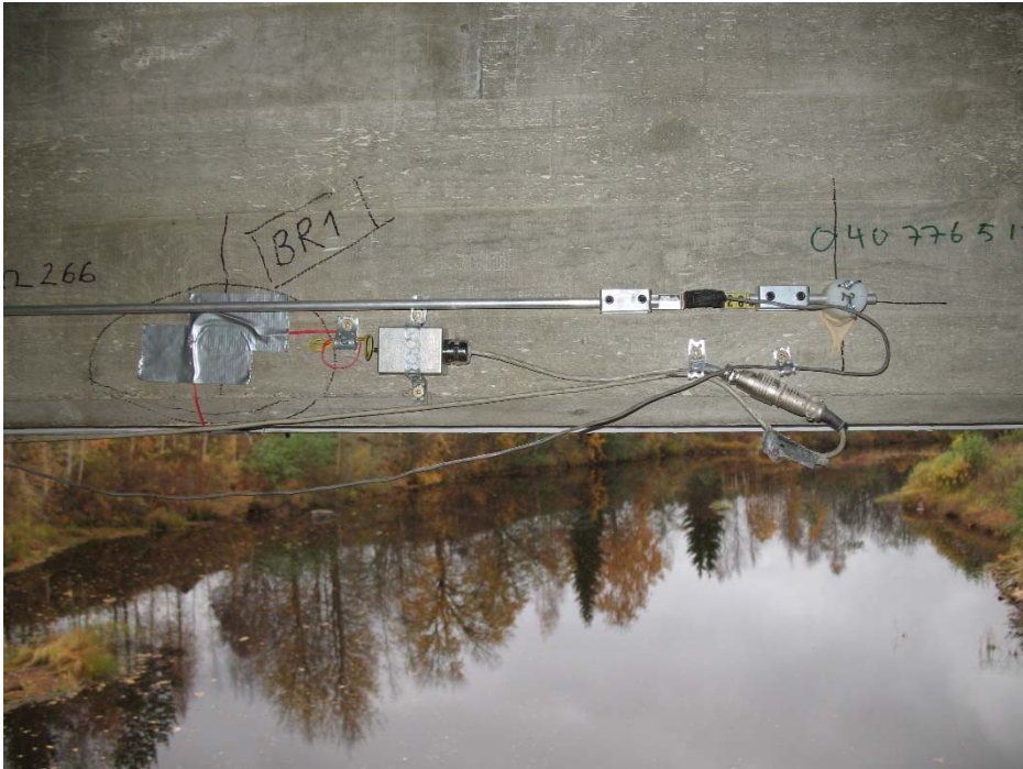
Kuva 13. Betonin venymän mittaaminen betonin pinnalta venymäliuskapohjaisella siirtymäanturilla yhden metrin matkalta (VTT).
