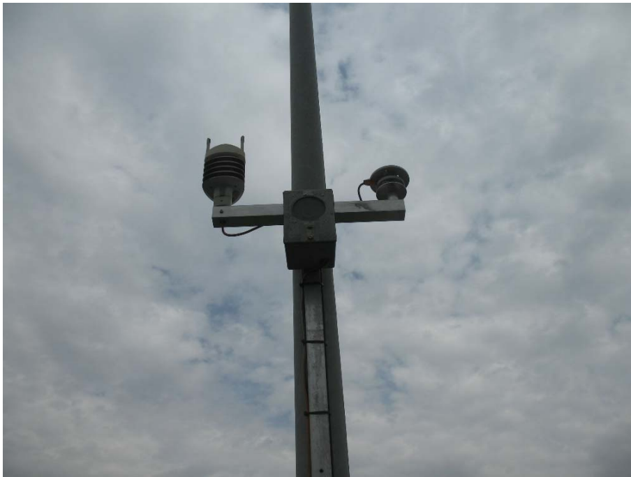
Kuva 20. Säätietojen ja auringon säteilyn mittaus sääaseman avulla (Vaisala Oy).
