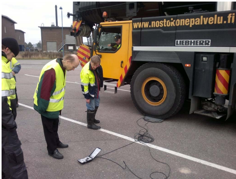
Kuva 17. Ajoneuvon akselipainojen punnitsemista akselipainovaaioilla koekuormituksessa
