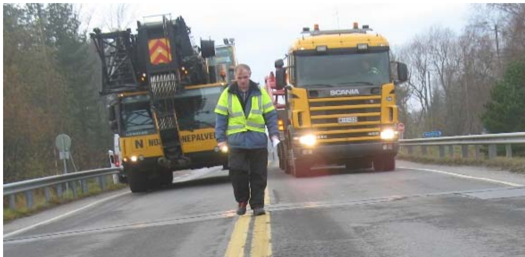
Kuva 26. Esimerkki koekuormituksesta ajoneuvonosturilla ja yhdistelmäajoneuvolla.
