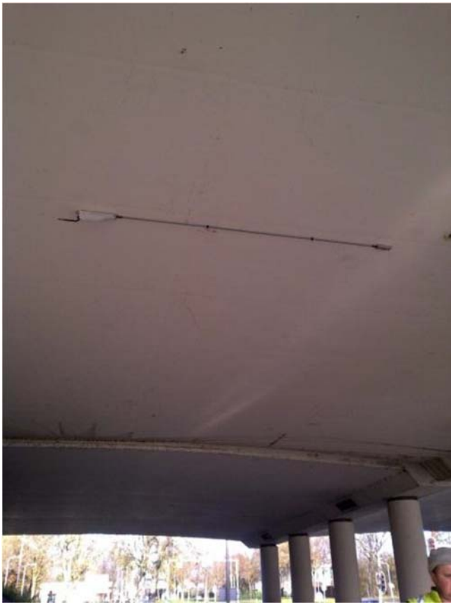
Kuva 14. Optinen 2 m:n valokuituanturi sillan pituuspalkin muodonmuutosten ja jännitystilojen mittaamisessa (OSMOS Group). Kuva Optimon Oy.
