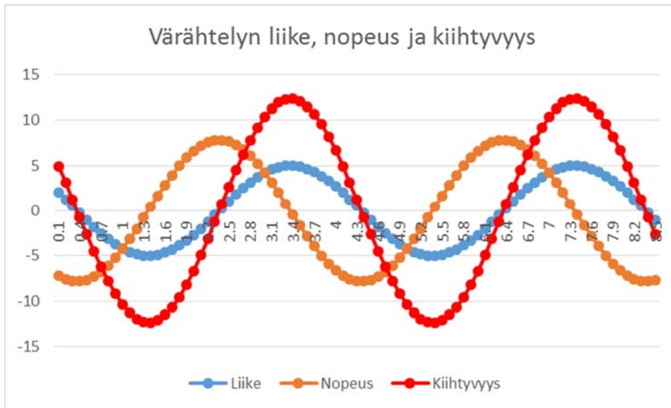
Kuva 15. Periaatekuva harmonisen värähtelyn liike, nopeus ja kiihtyvyys ajan funktiona.
