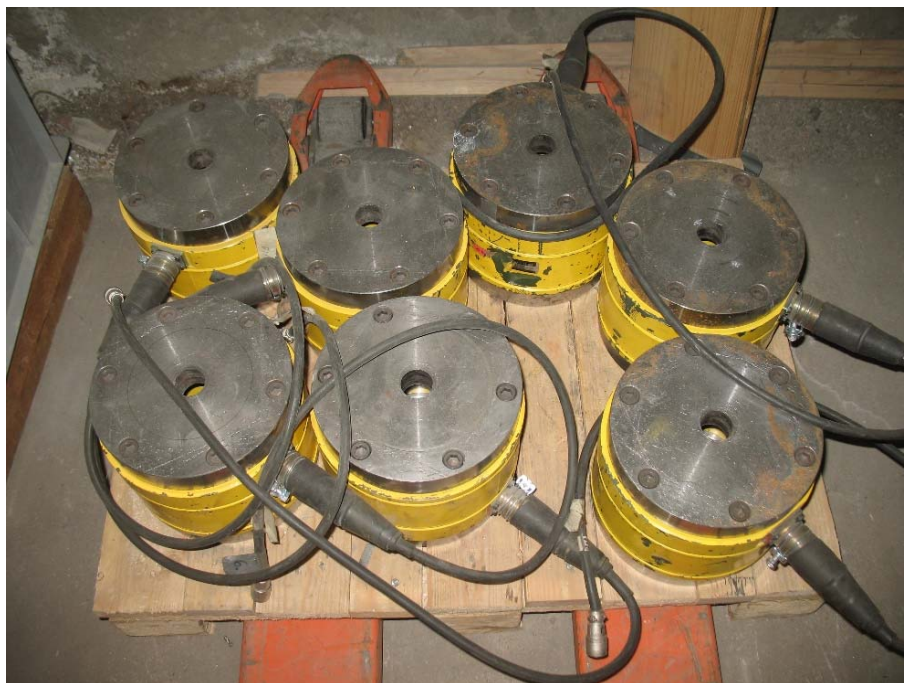
Kuva 18. Pitkäaikaisten ja suurten voimien (3 MN) mittaamiseen tarkoitettuja voima-antureita (Kyowa).
