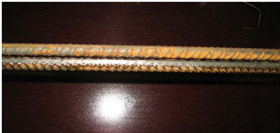
Kuva 12. Optinen valokuituanturi, jossa kuitu ja Braggin hilat on kiinnitettynä suojaan teräkseen jyr­sittyyn uraan (alempi teräs).
