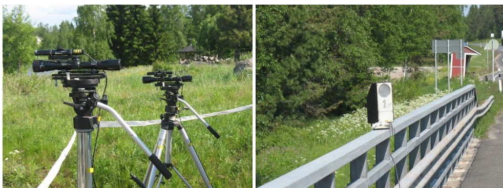
Kuva 5. Laser siirtymän mittalaite lähetin ja vastaanotin (Noptel Oy).
