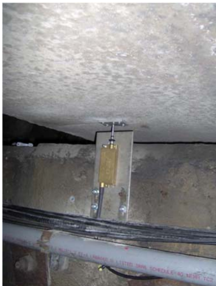
Kuva 7. Valokuituekstensiometrit sillan kannen painumamittauksessa (Chaplain Bridge, Montreal, Canada) (vasemmalla) ja sillan vaakaliitoksen muutoksen mittauksessa (Murtall Viadukt, Germany/Täv Rheinland) (oikealla). Kuvat Optimon Oy.
