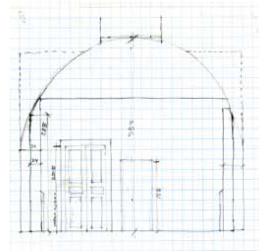
Esimerkki Hanssonin "mittauspiirustuksesta" eli ruutuperille tehdyistä tilakohtaisista muistiinpanoista, joita on Hanssonin toimiston arkistossa (paljon).
