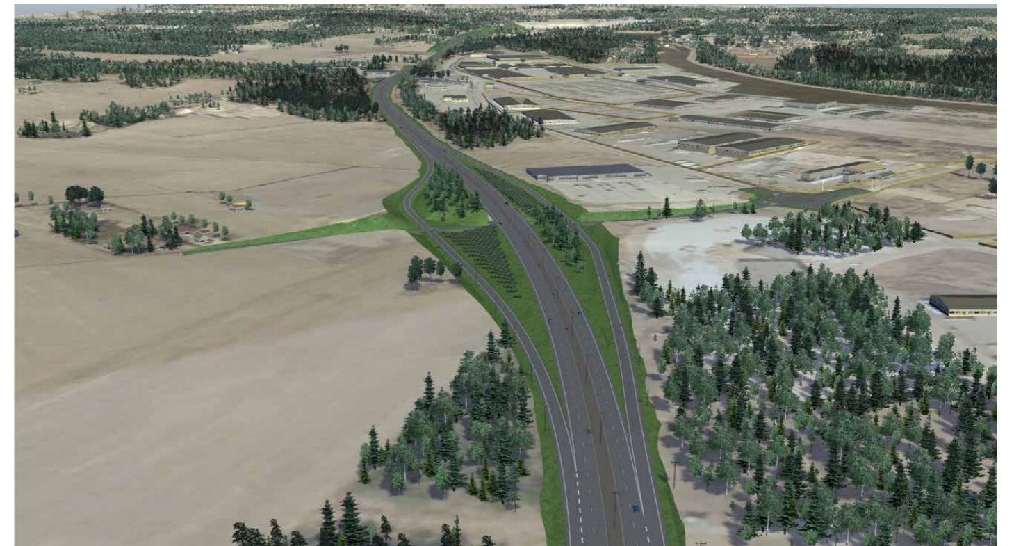
Kuva 5.25. Mälkiän ja Sataman välisen osuuden parantaminen turvaa alueen maankäytön kehittämisen. Havainnekuva Sataman eritasoliittymästä valtatie 6 suuntaan.
