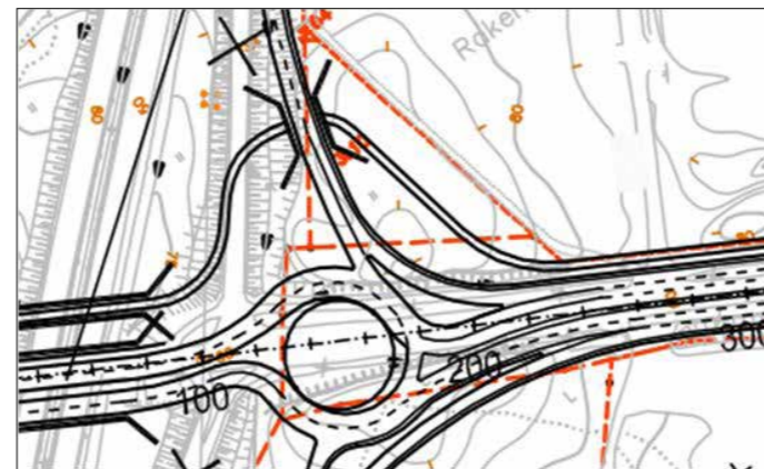
Kuva 3.5. Tutkittu jalankulun ja pyöräilyn alikuluvaihtoehto Mustolan eritasoliittymässä.
