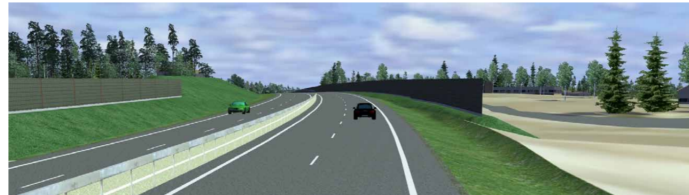
Kuva 5.8. Valtatien varren asutuksen kohdalle toteutetaan laaja meluntorjunta. Havainnekuva Metsä-Kansolan kohdalta Lappeenrannan suuntaan.
