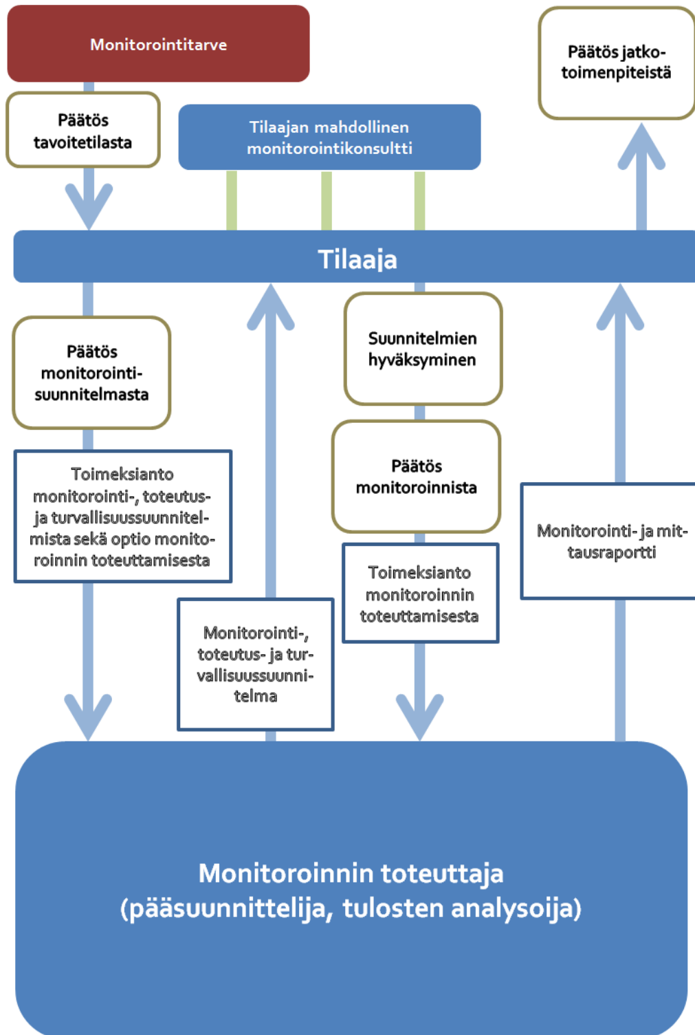
Kuva 2. Keskitetyn monitoroinnin prosessikaavio.
