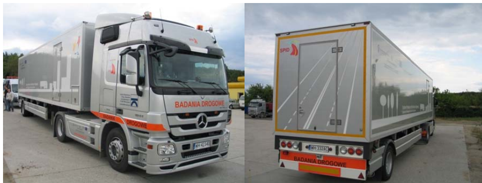
Kuva 24. Taipumien mittausauto – Traffic Speed Deflectometer (TSD).
