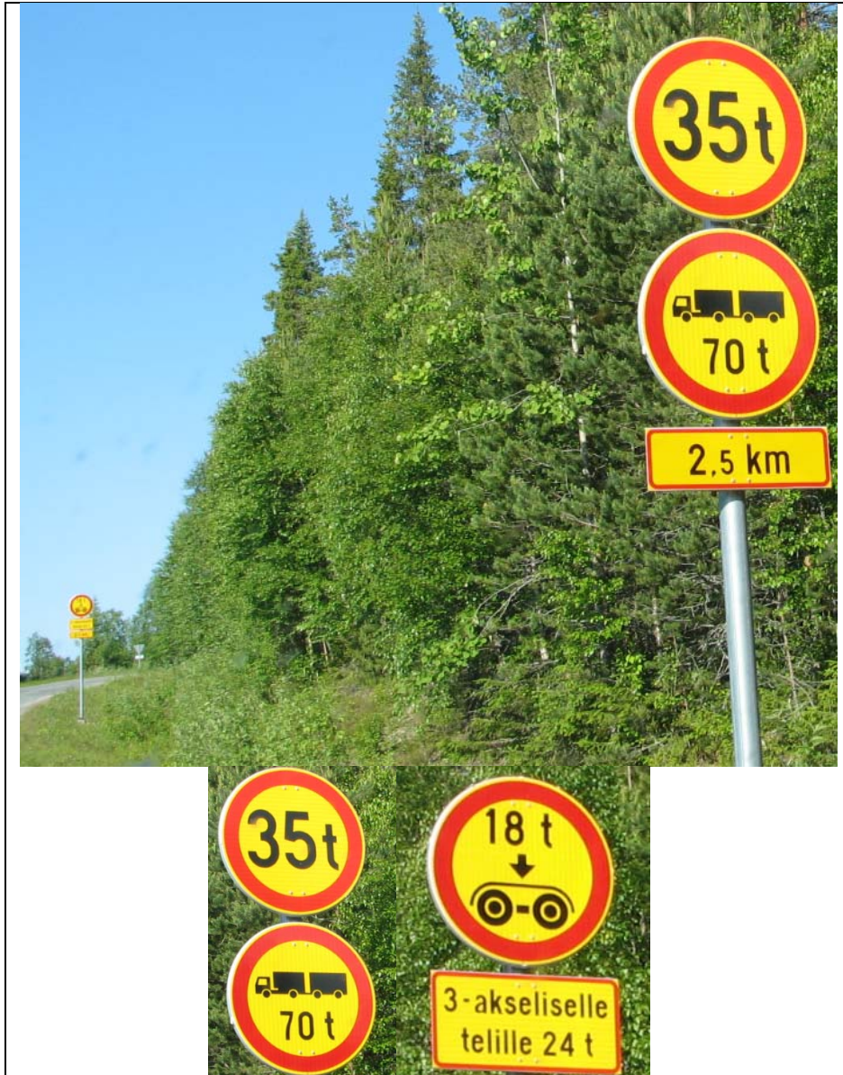
Kuva 8.3 Esimerkki sillan painorajoituksen esittämisestä. Kuvan painorajoitusmerkintä on -/18/24/35/70. Ajoneuvon sallittu massa on 35 t, yhdistelmän sallittu kokonaismassa 70 t, 2-akselisen telin sallittu massa 18 t ja 3-akselisen telin sallittu massa 24 t.
