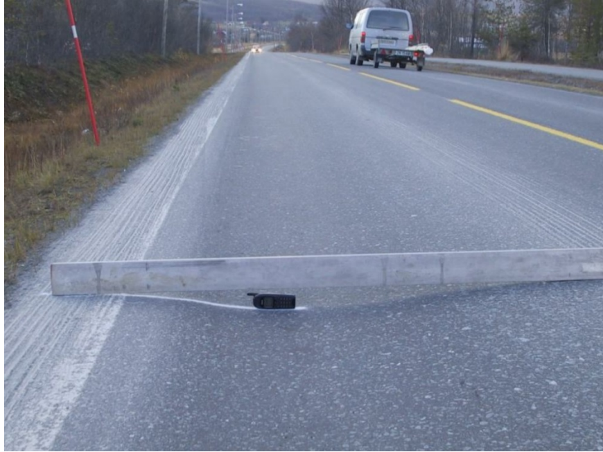
Kuva 31 Pohjamaan muodonmuutoksista aiheutuvaa laakeaa päällysteen urautumista (Saarenketo, 2014)
