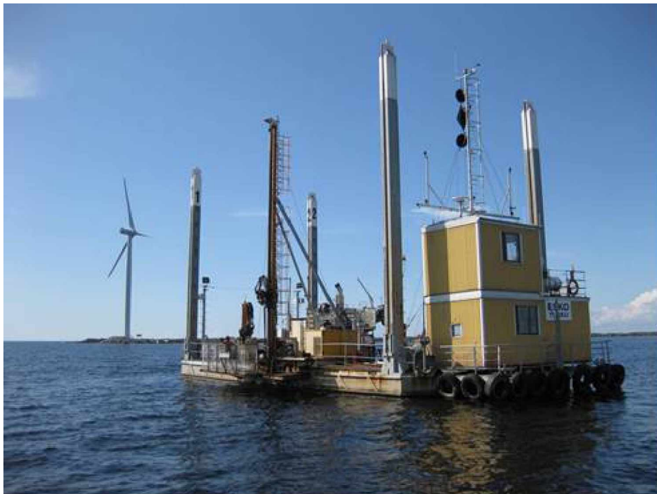
Kuva 9. Vesiväylätöiden pohjatutkimuksiin soveltuva tutkimuslautta. Lautan neljä tukijalkaa ovat tutkimuspisteen vaihdon ajan yläasennossa, kiinteästi asennettu porakonekaira lautaa vasemmassa reunassa.
