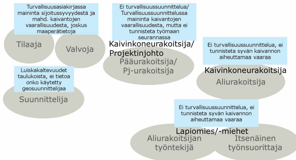
Kuva 16. Esimerkki tyypillisestä vesihuollon työmaan organisaatiosta.
