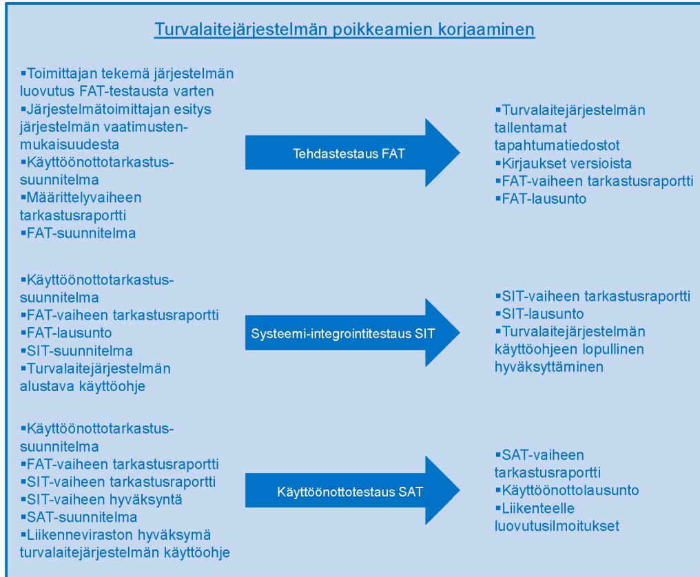
Kuva 5. Tehdastestaus-, systeemi-integrointitestaus- ja käyttöönottotestausvaiheiden prosessikaavio.
