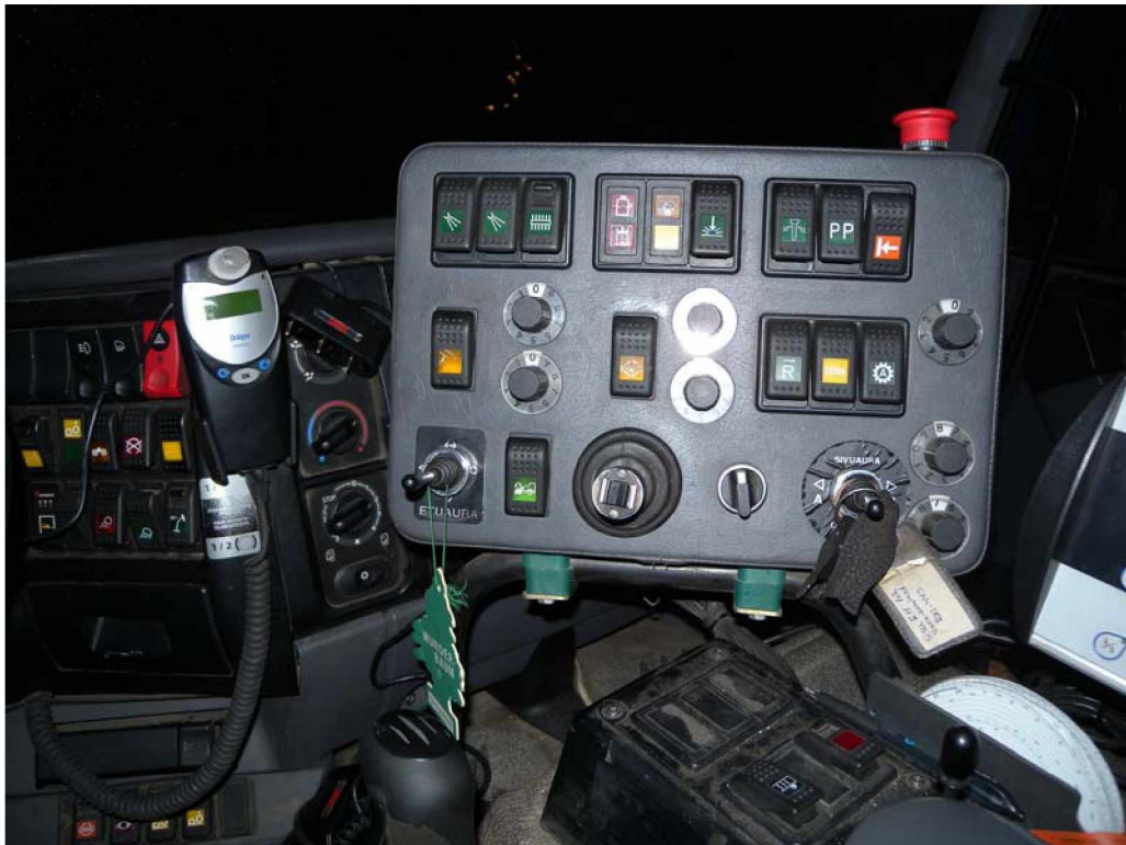
Kuva 9. Alkolukko osana tienhoitoauton kojelautaa. (Kuva: Antti Laine 2013)
