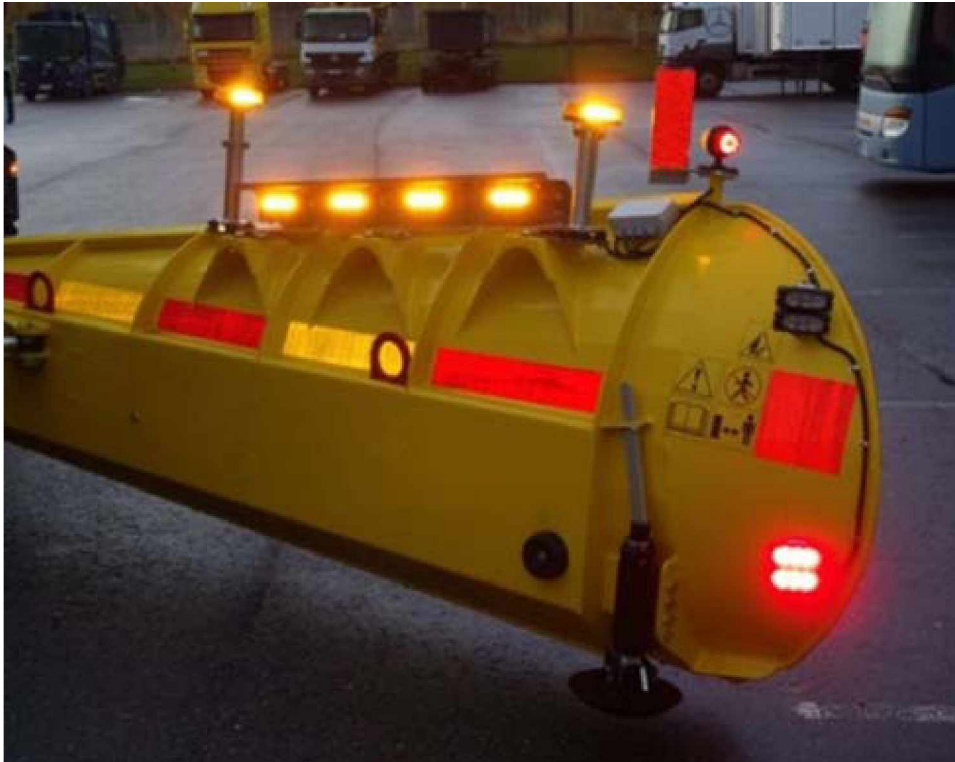
Kuva 5. Sivuauran näkevöittämlaitteisto. (Kuva: Mika Schroderus / YIT Kalusto Oy 2012)
