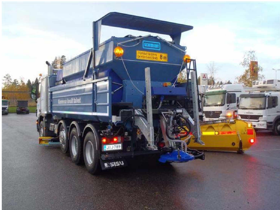
Kuva 10. Tienhoitoauto alusterällä, sivuauralla ja sirotinlaitteistolla varusteltuna. (Kuva: Mika Schroderus / YIT Kalusto Oy 2012)
