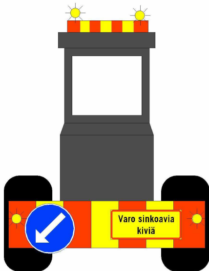
Kuva 2. Työkoneen varoituslaitteet niitto- ja vesakonraivaustyössä.
