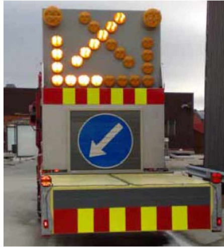
Kuva 11. Esimerkkikuva törmäysvaimentimesta ja sen varoituslevyistä ja -valoista. (Statens Vegvesen 2011)
