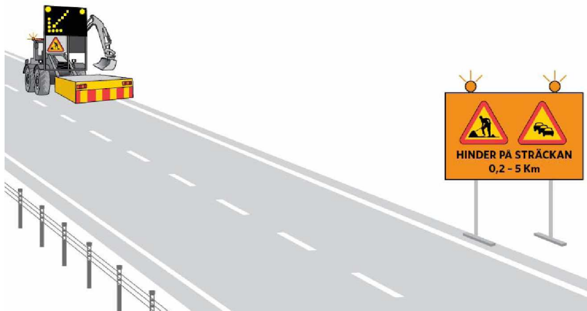
Kuva 9. Esimerkkikuva ennakkovaroitustavasta tilanteesta, jossa varoitusajoneuvoa ei voida käyttää (varoitussajoneuvo ei mahdu pientareelle). (Trafikverket 2013b)
