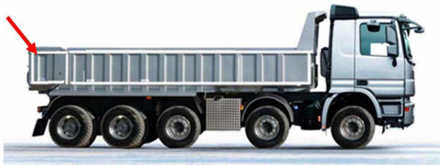
Kuva 5. Esimerkkikuva heijastavista ääriiviivamerkinnöistä maansiirtoautossa. (Heijastavat ääriiviivamerkinnät raskaissa ajoneuvoissa, Trafi)
