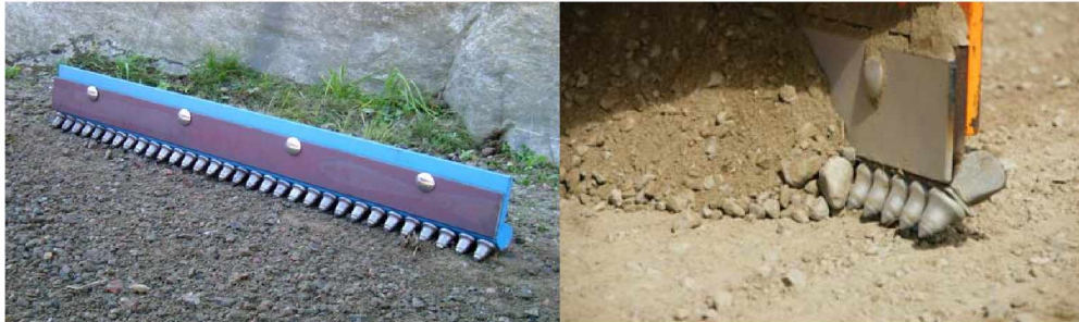
Kuva 27. Tappiterällä on parhaat leikkaavat ominaisuudet.
