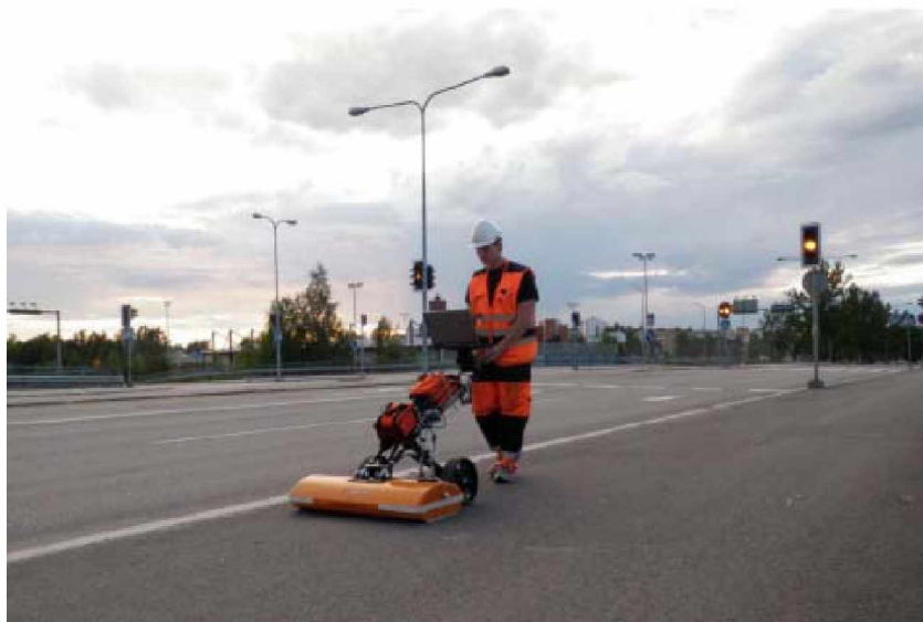
Kuva 2.1 Sillan kansi tutkattiin kokeeksi myös uudella IDS:n mittauskalustolla.
