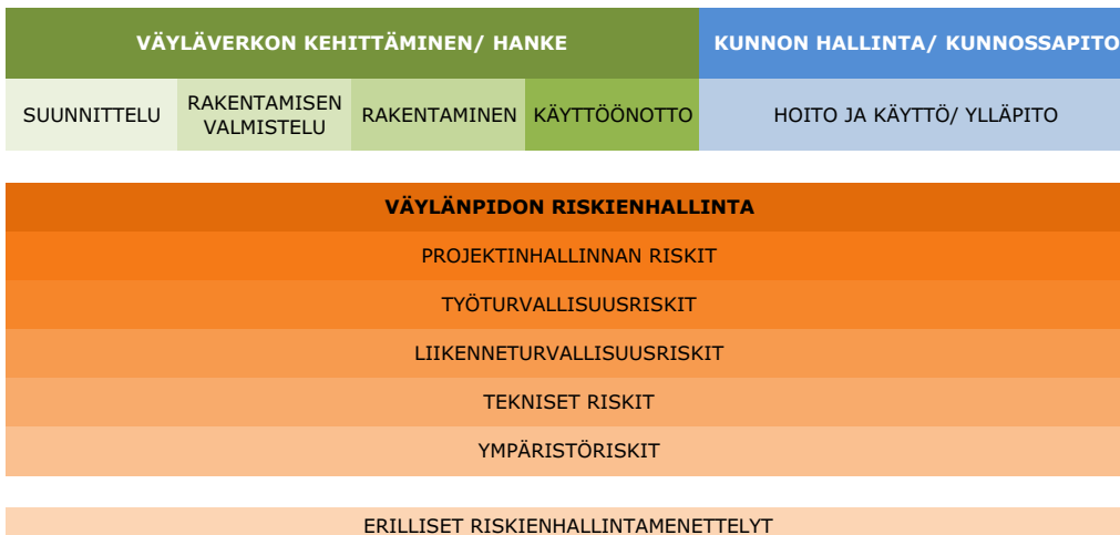
Kuva 1. Hankkeen (väyläsuunnittelu ja -rakentaminen) ja kunnan hallinnan (kunnossapidon) elinkaariajattelu vaiheineen operatiivisessa toiminnassa.
