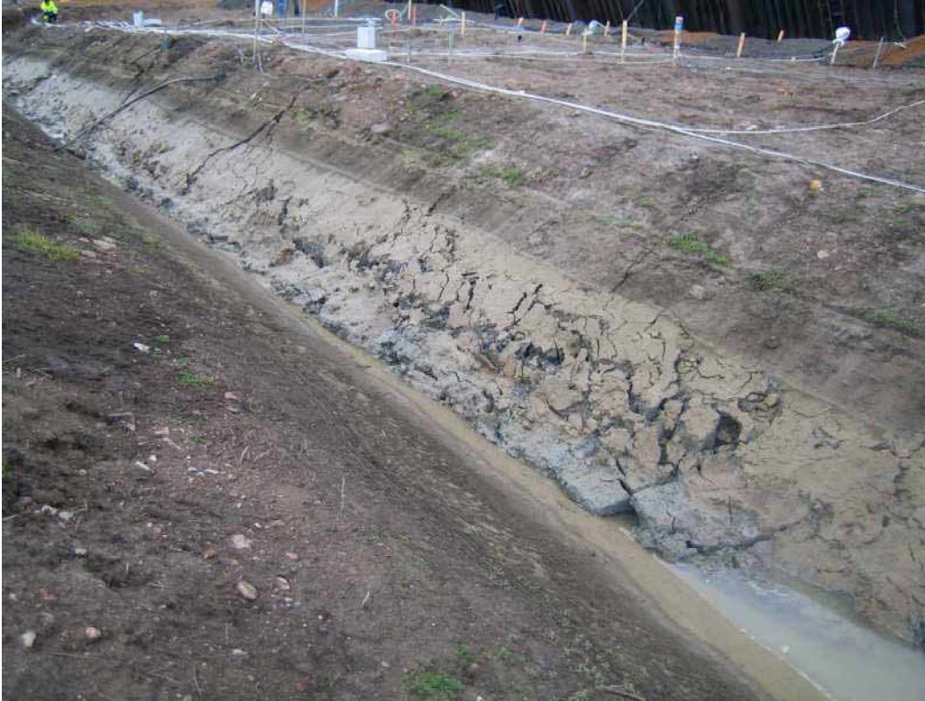
Kuva 48. Liukupinnan passiivipää ojan pohjalla ojan takaa kuvattuna. Kuvan vasemmassa yläkulmassa näkyy maanpinnan nousu koealueen keskiosassa.
