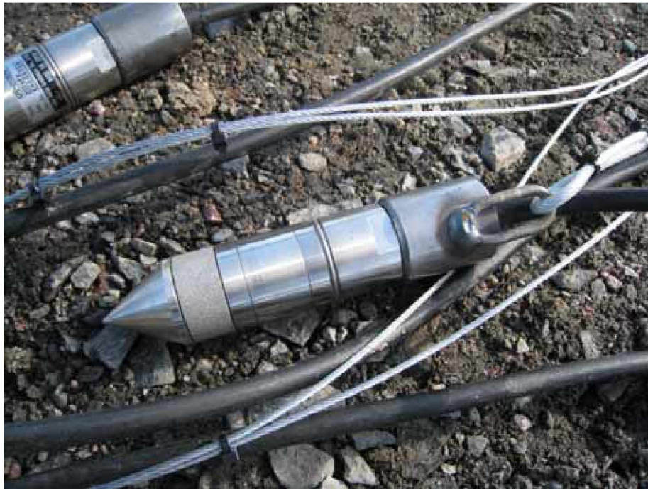
Kuva 19. Ilman vartta asennettava Tokyo Sokki -huokospaineanturi. Anturin pe-rään on liitetty kierreholkki, joka liikuu asennusputken päähän. Asen-nusputki on holkissa sen verran väljästi, että putkea nostettaessa anturi jää siihen syvyyteen mihin se on painettu. Lenkkiin kiinnitetyllä vaijerilla anturi voidaan vetää maasta pois kokeen jälkeen. Kuva Kauko Sahi.
