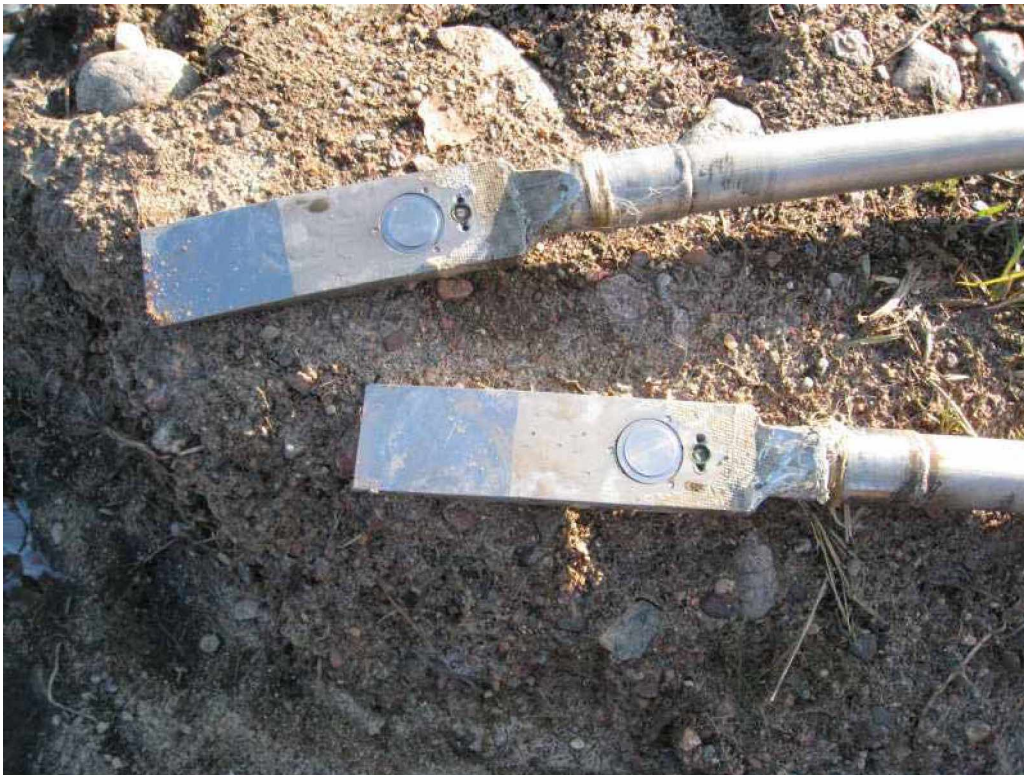
Kuva 25. Yhdistetyt vaakasuuntaiset maanpaine- ja huokospaineanturit (‘kirveenterät’). Suuri ympyränmuotoinen osa on maanpaineanturin kalvo, kun taas pienempi kolo sen yläpuolella on huokospaineanturin huokoskivi. Kuva Kauko Sahi.
