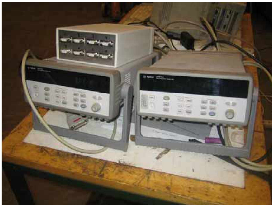
Kuva 34. Kokeessa analogisten anturien lukemiseen käytettyjä Agilent-dataloggereita. Toisen loggerin päällä on kytkentälaatikko, jolla loggeriin voidaan liittää 9-pinnisiä D-liittimiä. Loggerien kanavakortteihin voidaan liittää antureita suoraan vain 25-pinnisillä liittimillä (vasemmanpuoleisen loggerin alla).
