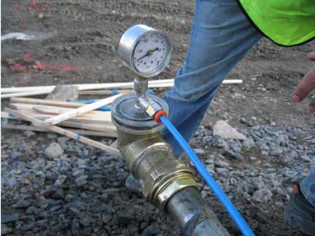
Kuva 39. Huokospaineanturin ilmaus työmaalla. Kuvassa paine ei vielä ole laskeutunut täyteen tyhjiöön. Kuva Kauko Sahi.
