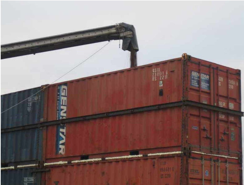
Kuva 41. Konttien kuormasta hihnakuuljettimella. Pällekkäisten konttien väliin jäävä rako on tukittu paisuvalla uretaanimassalla.
