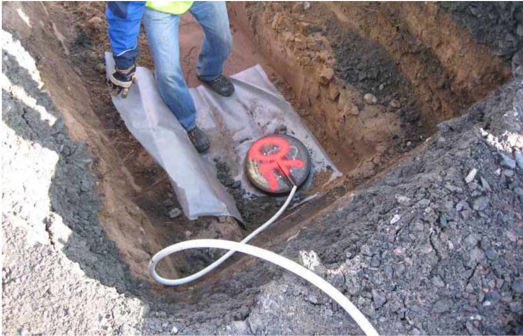
Kuva 38. Maanpaineanturin asentamista penkereen alle. Anturin johto on suojattu taipuisalla sähköputkella. Kuva Kauko Sahi.
