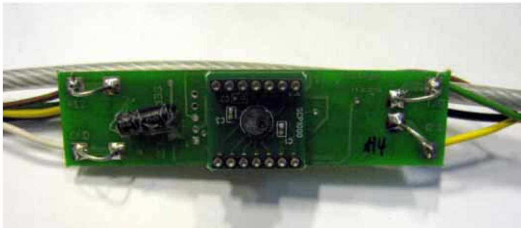
Kuva 22. TTY:n painumaletkussa käytettävä anturipiiri. Itse paineanturi on pyöreä, halkaisijaltaan 6 mm komponentti piirin keskellä. Piirilevy, signaali-johtimet ja käyttöjännitejohtimet on kiinnitetty taustalla näkyvään muovipäällysteiseen kaapeliin, jonka avulla anturiletkaa voidaan liikutella letkun sisällä. (Luomala 2009 s. 26)
