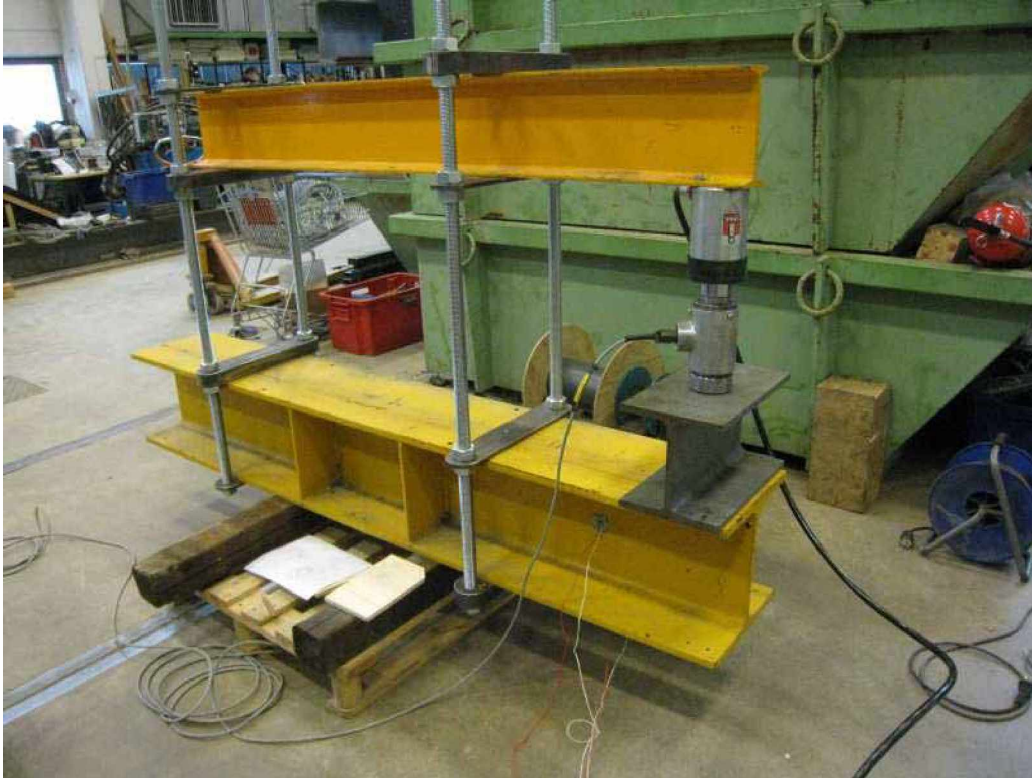
Kuva 29. Venymäliuskojen kalibrointijärjestelyn testausta TTY:n rakennushallissa. Työmaalla liuskat kalibroitiin siten, että kuormituspalkin (ylhäällä) kiinnikkeet tulivat kiskojen väliin.
