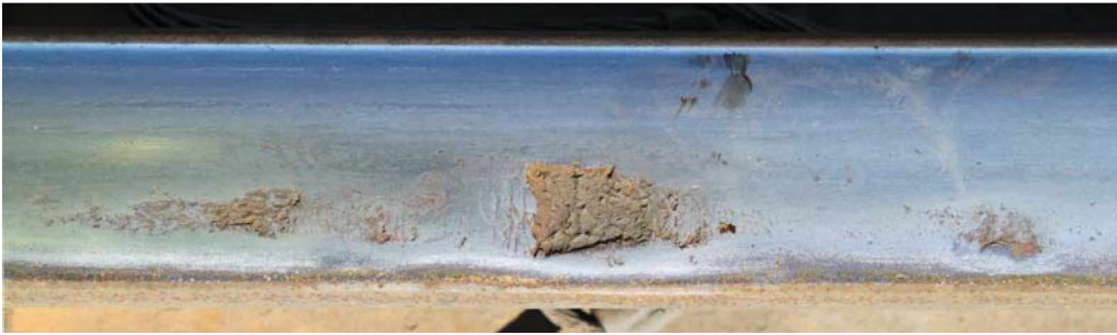
Kuva 25 Toistuvien ympärilyöntien tuottama jälki kiskossa.
