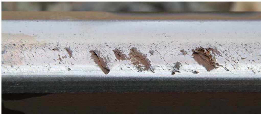
Kuva 31 Pintaan ydintyneitä vierintäväsymissäröjä ja sälöilyä kiskon hamarassa.
