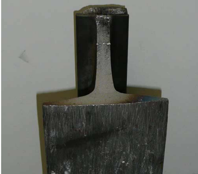
Kuva 13 Kisko, jonka jalka on vaurioitunut virheellisen siirron seurauksena. Jalka on ohentunut kulumisen seurauksena huomattavasti ja sen väri on muuttunut kuumenemisen seurauksena.
