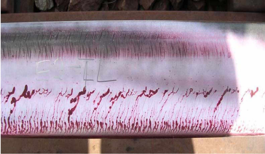
Kuva 42 Kiskon hamara, joka on tarkastettu tunkeumanesteen avulla [69].
