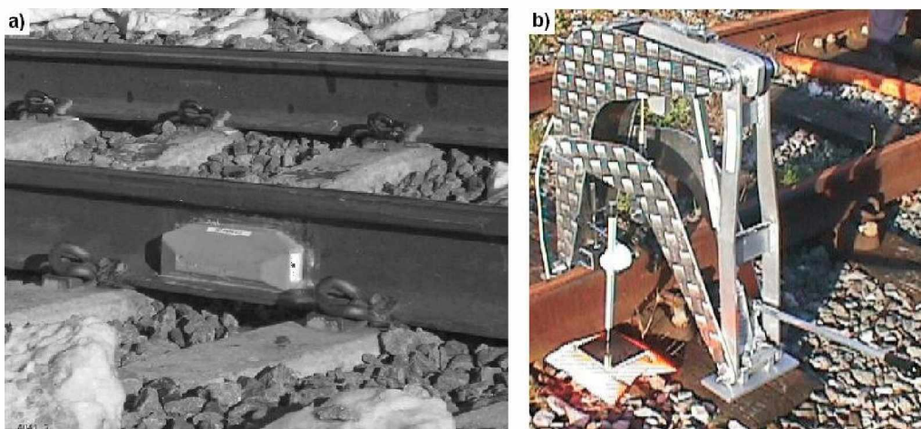
Kuva 64 Neutraalilämpötilan mittaukseen tarkoitettu a) venymäliuskoihin perustuva mittalaite [89] sekä b) kiskon nostoon perustuva mittalaite VERSE [90].
